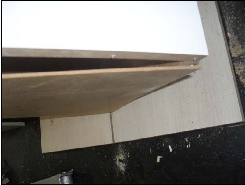
Şekil 3.20 Diyagonal basınç deneyinde arkalık sabitleme türü havalı çivi olan örneklerde kırılma tipi.
