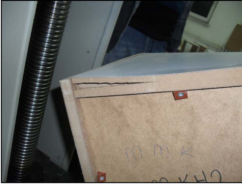
Şekil 3.22 Diyagonal basınç deneyinde arkalık sabitleme türü plastik bağlantı elemanı olan örneklerde kırılma tipi.
