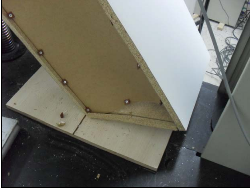
Şekil 3.21 Diyagonal basınç deneyinde arkalık sabitleme türü plastik bağlantı elemanı olan örneklerde kırılma tipi.
