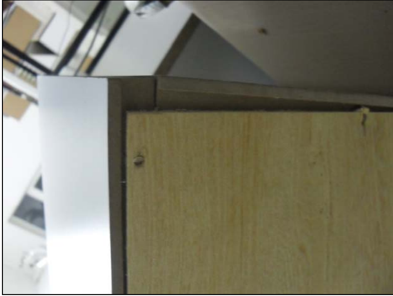
Şekil 3.14 Diyagonal basınç deneyinde arkalık sabitleme türü çivili olan örneklerde kırılma tipi.
