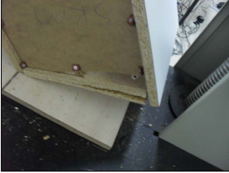
Şekil 3.23 Diyagonal basınç deneyinde arkalık sabitleme türü plastik bağlantı elemanı olan örneklerde kırılma tipi.
