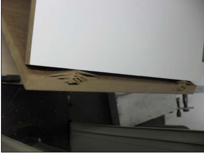
Şekil 3.13 Diyagonal basınç deneyinde arkalık sabitleme türü çivili olan örneklerde kırılma tipi.
