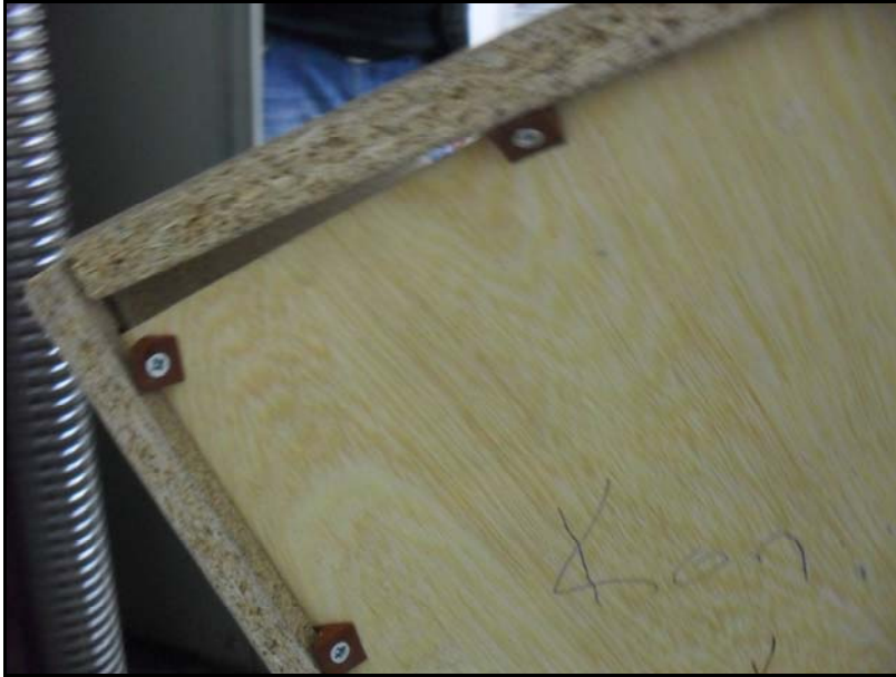
Şekil 3.24 Diyagonal basınç deneyinde arkalık sabitleme türü plastik bağlantı elemanı olan örneklerde kırılma tipi.
