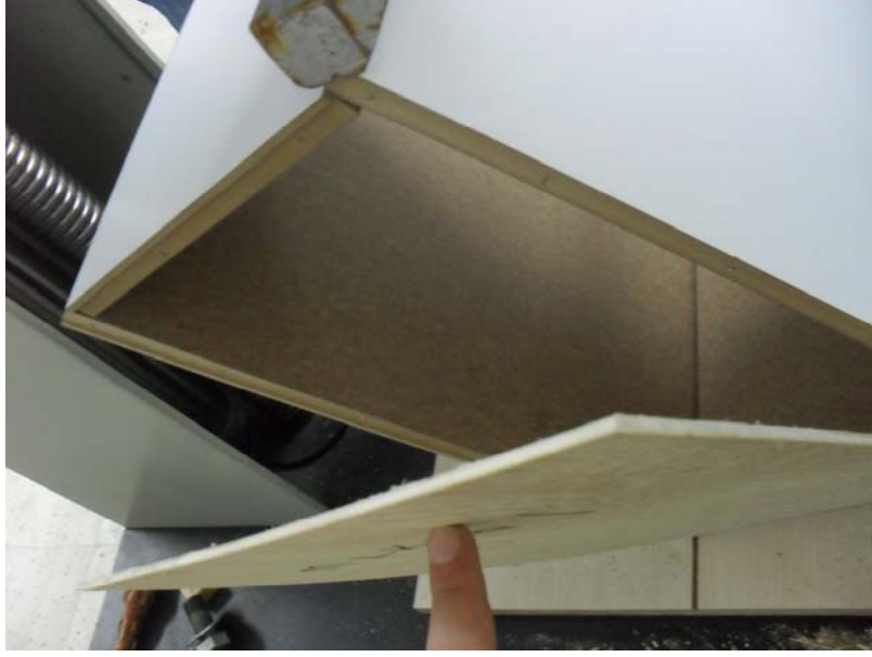
Şekil 3.19 Diyagonal basınç deneyinde arkalık sabitleme türü havalı çivi olan örneklerde kırılma tipi.
