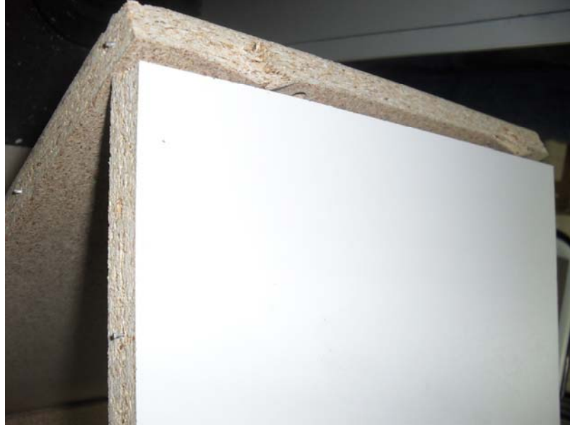
Şekil 3.18 Diyagonal basınç deneyinde arkalık sabitleme türü havalı çivi olan örneklerde kırılma tipi.
