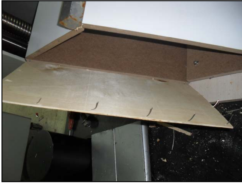
Şekil 3.12 Diyagonal basınç deneyinde arkalık sabitleme türü çivili olan örneklerde kırılma tipi.
