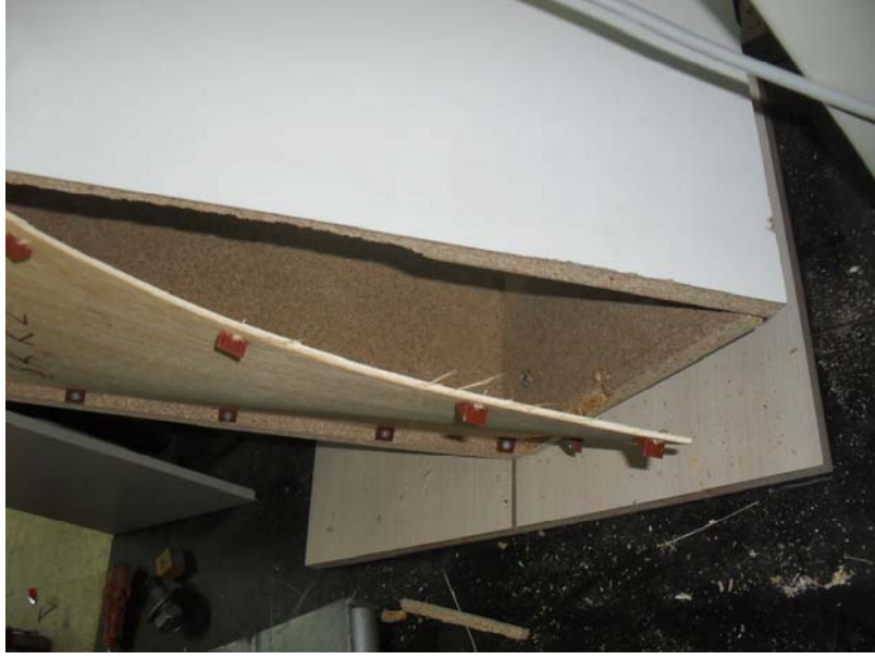
Şekil 3.25 Diyagonal basınç deneyinde arkalık sabitleme türü plastik bağlantı elemanı olan örneklerde kırılma tipi.
