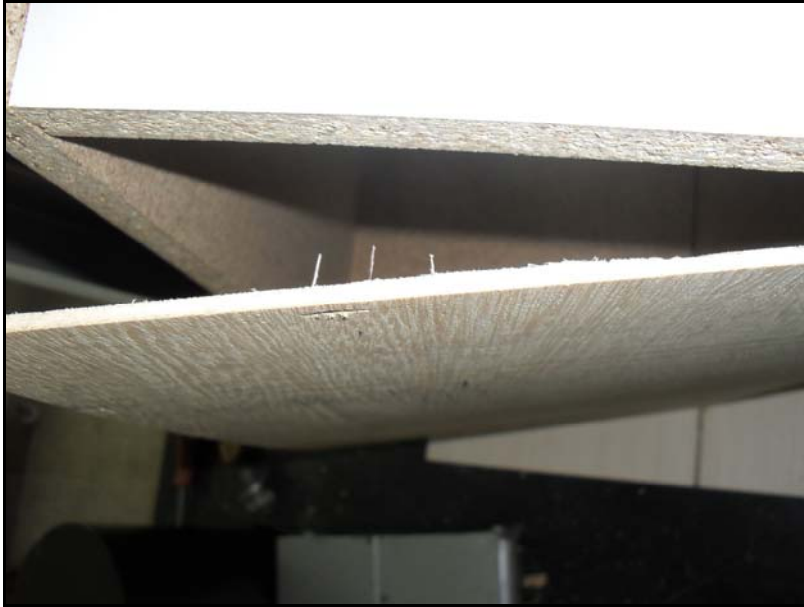
Şekil 3.16 Diyagonal basınç deneyinde arkalık sabitleme türü zımbalı olan örneklerde kırılma tipi.
