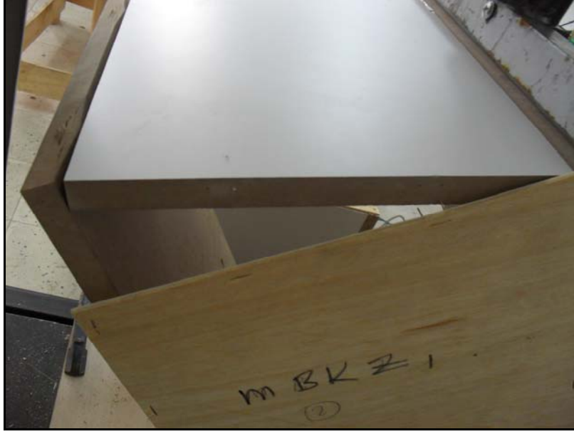
Şekil 3.17 Diyagonal basınç deneyinde arkalık sabitleme türü zımbalı olan örneklerde kırılma tipi.
