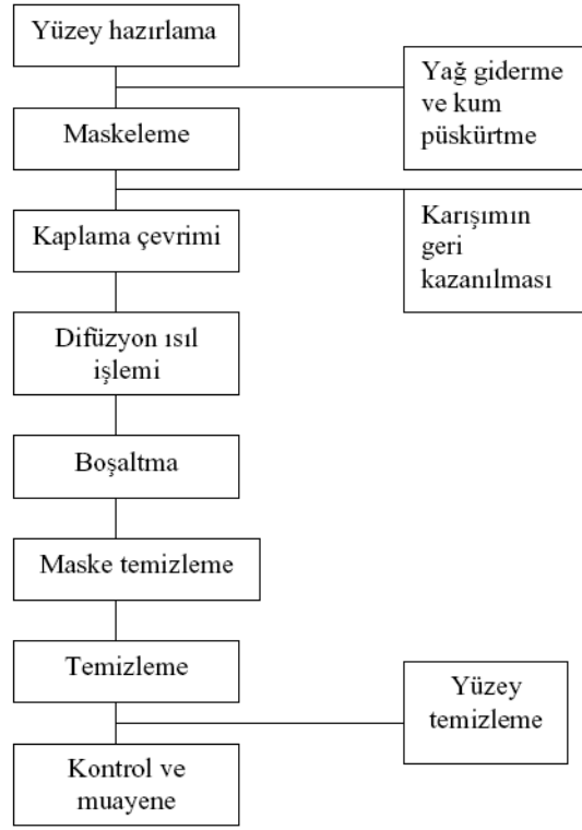
Şekil 2.3 TRD prosesinde işlem sırası (Yılmaz 2008).
