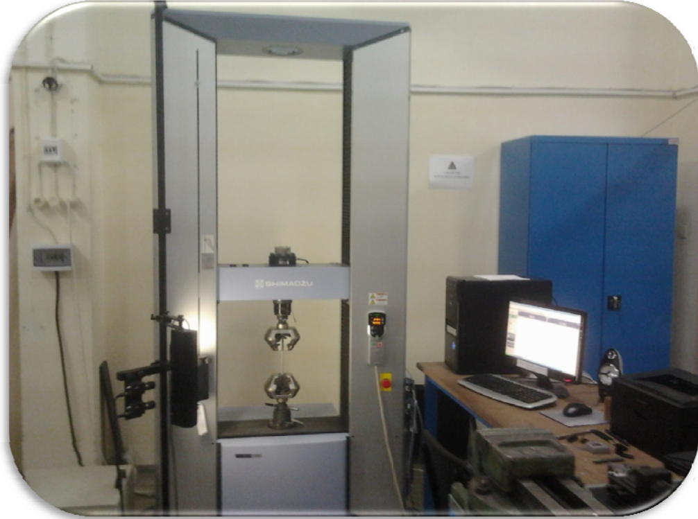
Şekil 9.2 Üniversal çekme cihazı.
