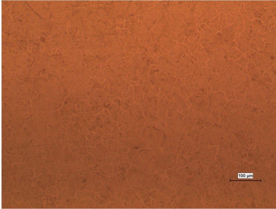
Şekil 10.7 AISI 1020 çeliğinin 1100 °C’de tavlama ısıl işlemine tabi tutulmuş optik mikroyapı fotoğrafı (x100).
