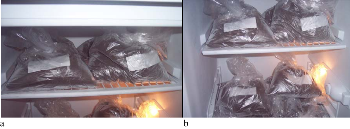
a b Şekil 2.15 Mikoriza için alınan toprak örneklerinin buzdolabında muhafaza edilmesi (a,b).
