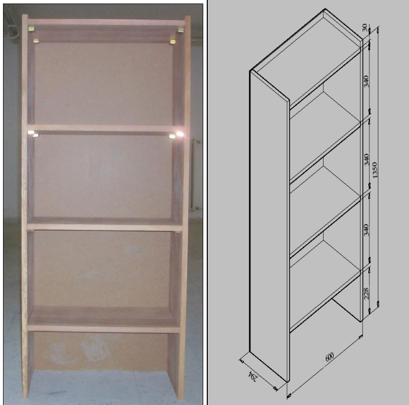
Şekil 3.9 Kutu tipi mobilya ölçüleri (mm).
