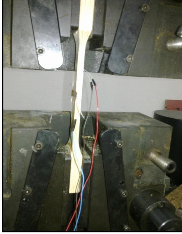
Şekil 2.14 Poisson oranının strengaç yardımıyla belirlenmesi.
