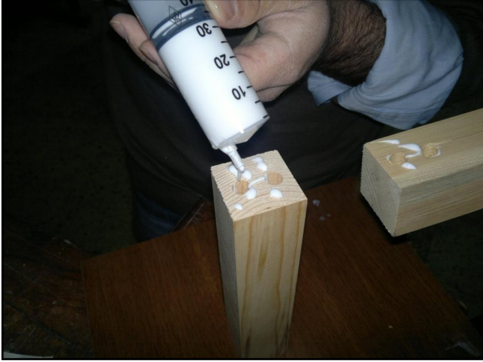
Şekil 2.1 Yüzeyle sürülen tutkalın enjektörle ayarlanması.
