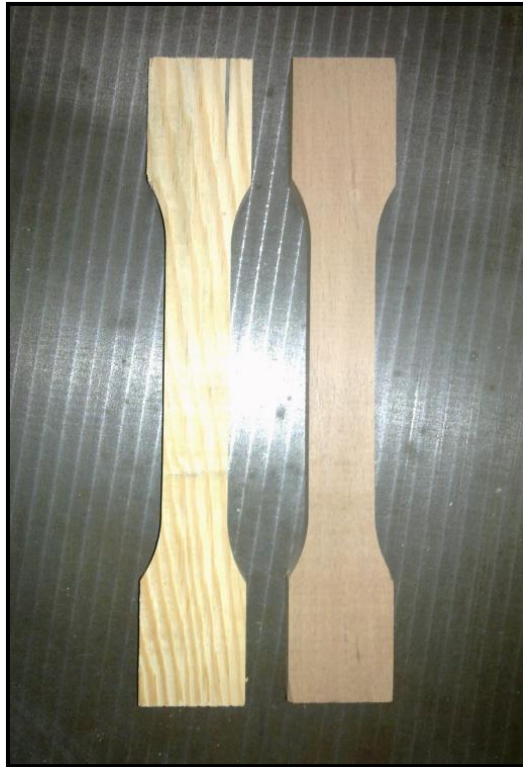
Şekil 2.12 Liflere paralel çekme direnci deney örnekleri.
