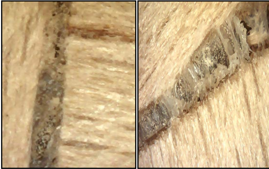
Şekil 2.2 Tutkal katmanları a. Basınc deneyi öncesi, b. Basınc deneyi sonrası.
