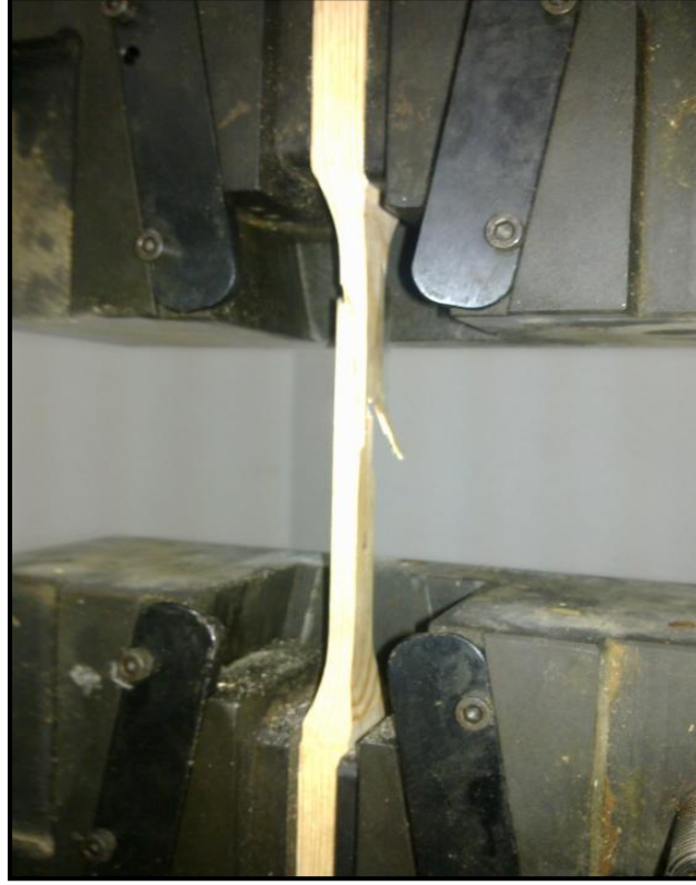
Şekil 2.13 Liflere paralel çekme direnç deneyi örneği.
