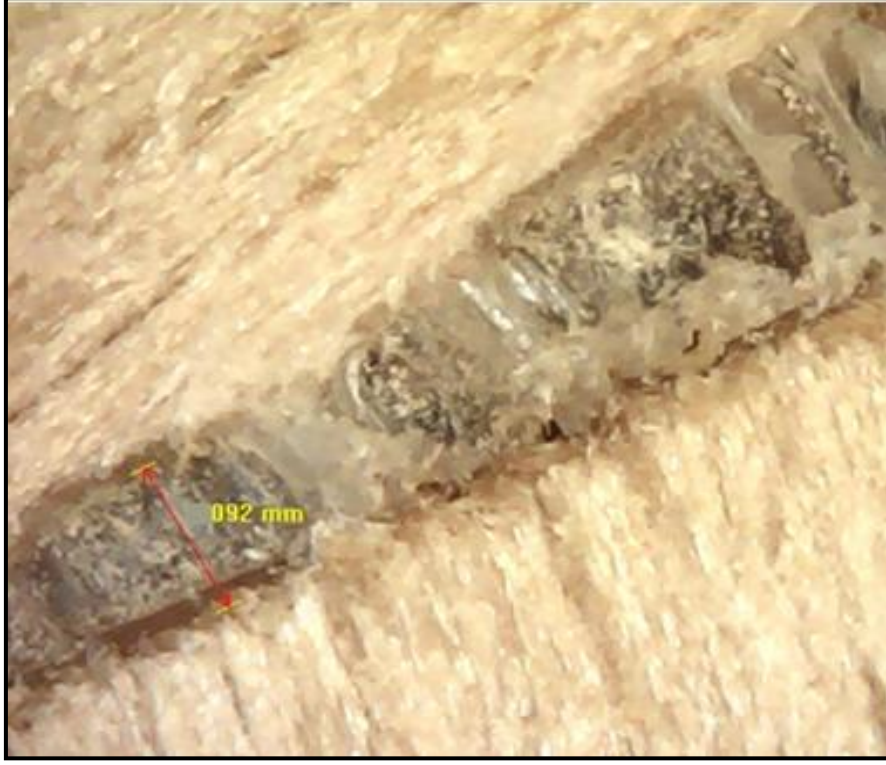
Şekil 1.9 Ahşap birleştirmeler arasındaki tutkal katmanı kalınlığı.
