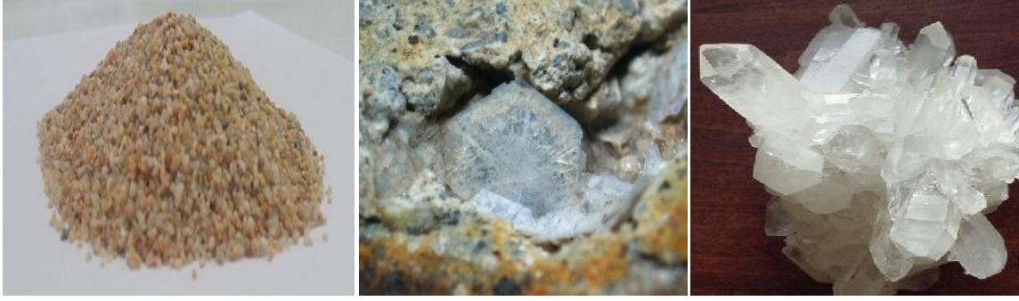
a) b) c) Şekil 2-4 Silikanın 3 ana formu a) kristobalit b) tridimit c) kuvars
