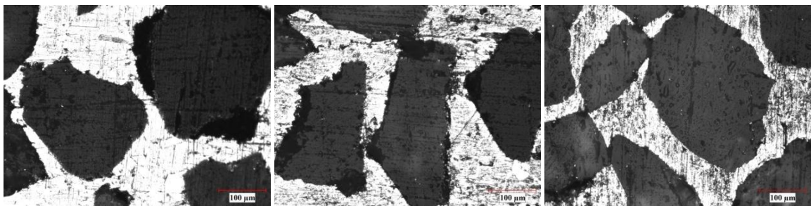
řekil 4-17 İkili modelde matrise farklı Mg ilavesi durumunda üretilen numunelerin optik mikroskop görüntüleri a) %0 b) %4 c) %8
