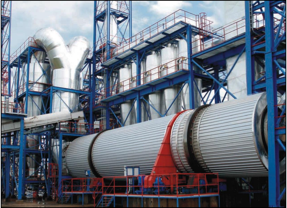
Şekil 1.3 Tek geçişli kurutma tamburu (URL-3, 2013).
