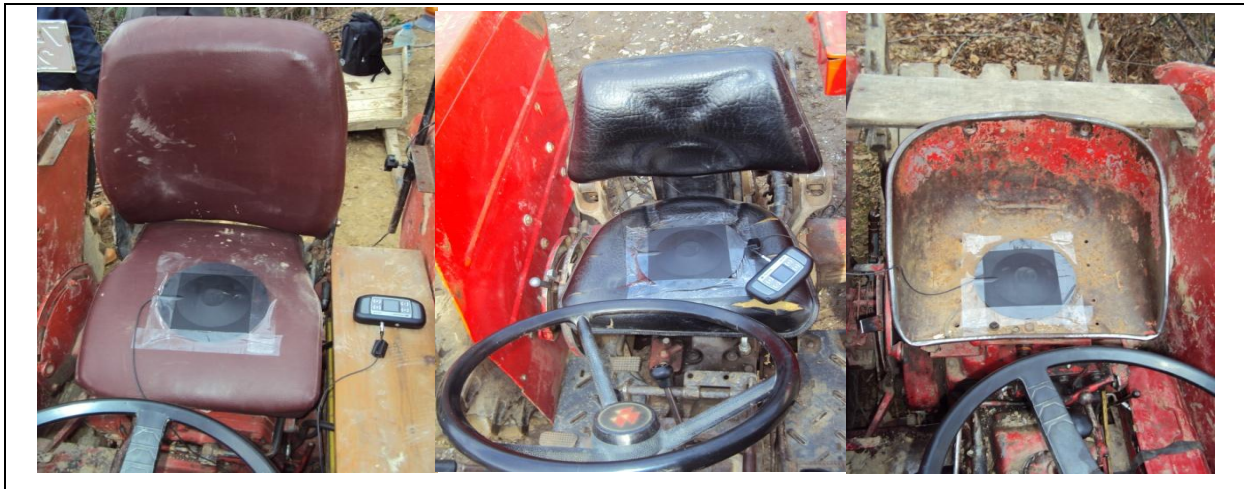
Şekil 2.6 Mevcut traktör koltukları üzerinde titreşim ölçümü (Orjinal 2012).
