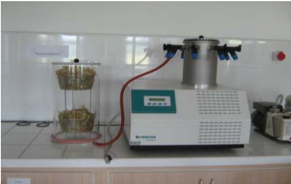
Şekil 2.3 Telstar Cyrodos-50 marka donduruculu kurutucu (Foto :Pınar TAMTÜRK).
