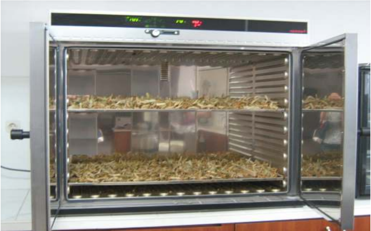
Őekil 2.2 Fırında kurutma iin kullanılan laboratuvar tipi etv (Foto :Pınar TAMTRK)
