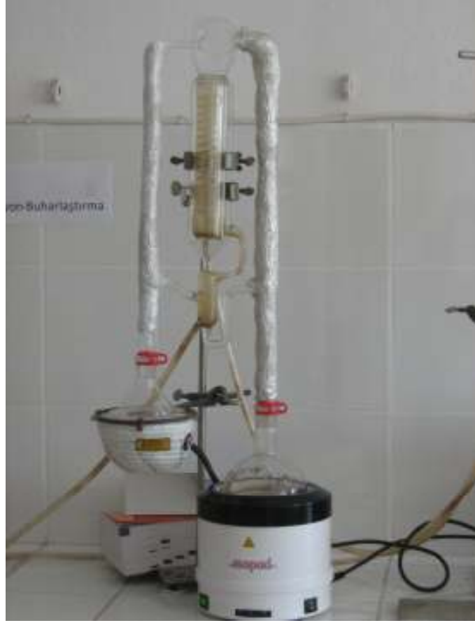
Şekil 2.5 SDE (Simultaneous Distilasyon-Ekstraksiyon) düzeneği (Foto:Pınar TAMTÜRK).
