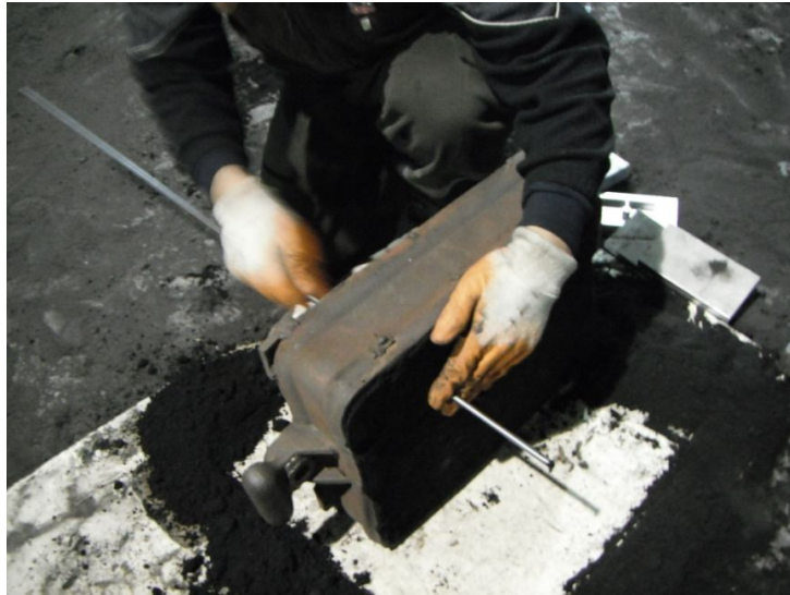
Şekil 8.1 Derecenin yolluk girişlerinin verilmesi.
