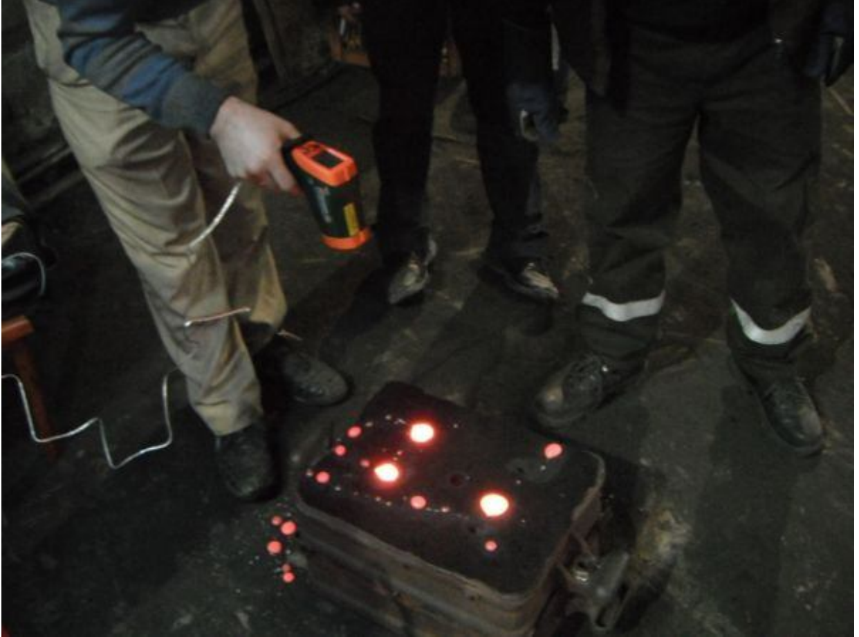
Şekil 8.4 Kızılötesi termometre yardımıyla sıcaklık ölçümü.
