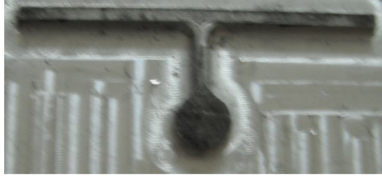
Şekil 7.6 Et kalınlığı 3-5 mm ürünler için işlenmiş 5*5*100 mm'lik model.
