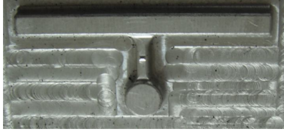
Şekil 7.7 Et kalınlığı 5-10 mm ürünler için işlenmiş 10*10*100 mm'lik model.
