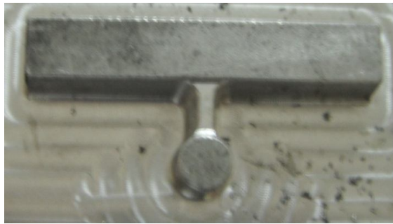
Şekil 7.9 Et kalınlığı 15-20 mm ürünler için işlenmiş 20*20*100 mm'lik model.
