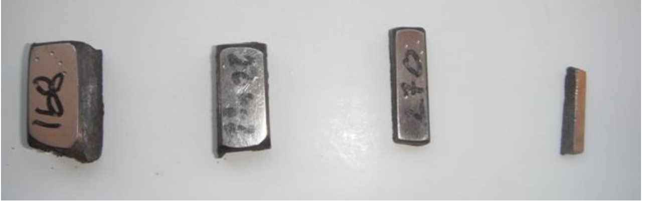
Şekil 9.2 Mikro yapı ve sertlik ölçümü için parlatılan döküm malzemeleri.
