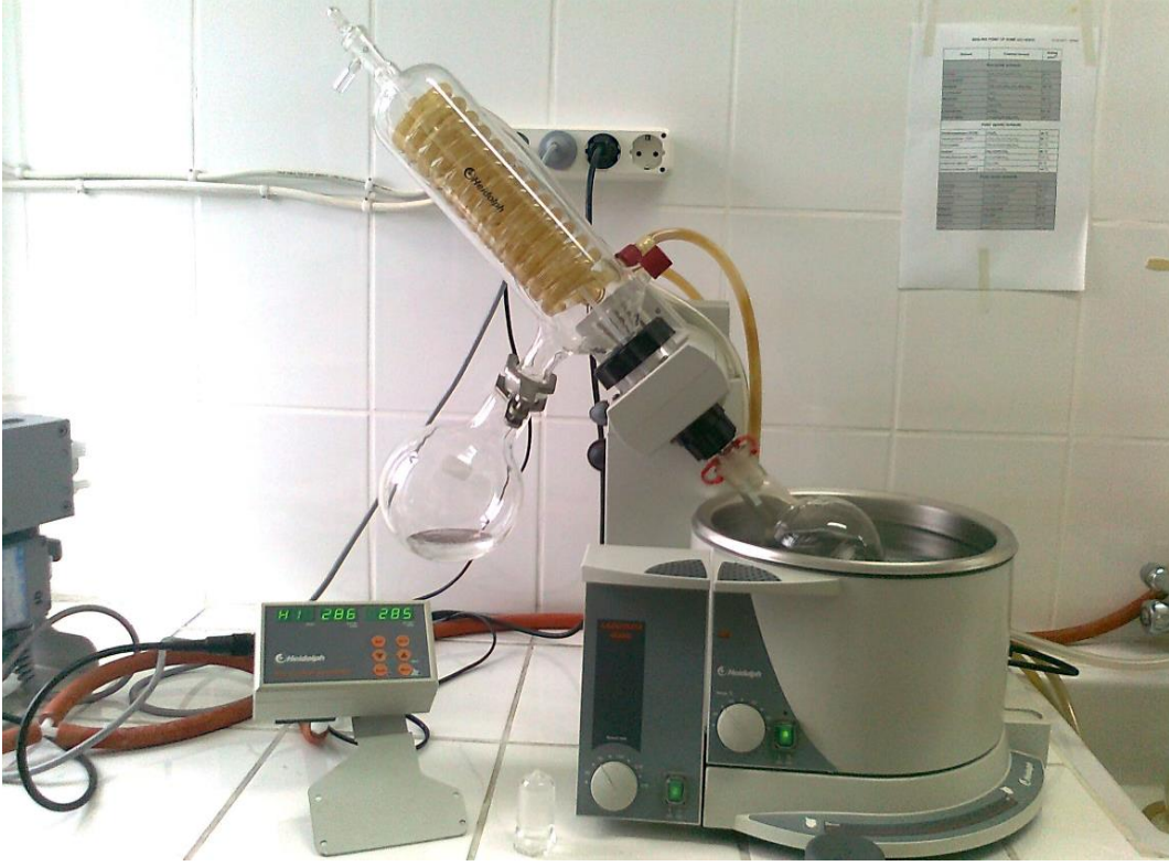
Şekil 2.2 Döner buharlaştırıcıda çözücünün uzaklaştırılması.
