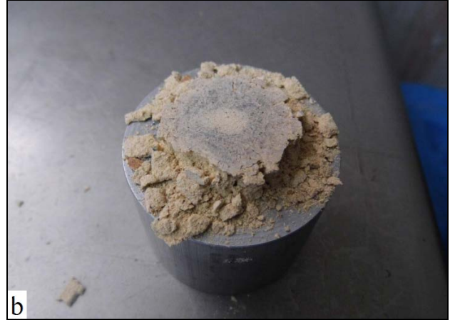
Şekil 3.9 a) Bartın Çimento (Sanko Holding)'da bulunan mekanik test cihazı, b) basma testi uygulanmış numune.
