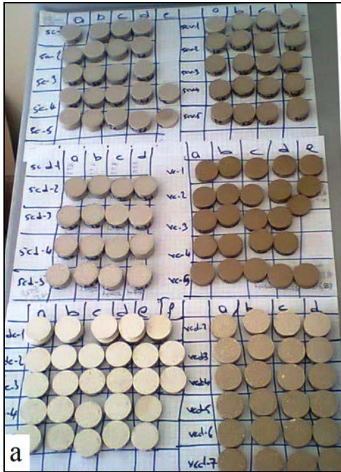
Şekil 3.6 Kalıptan çıkarılan numuneler. Sinterleme öncesi (a) ve sonrası (b).
