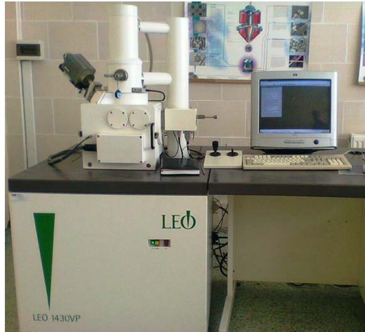
Şekil 3.10 AKU-TUAM'da bulunan taramalı elektron mikroskobu (SEM).
