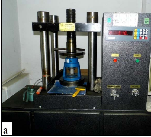
Şekil 3.9 a) Bartın Çimento (Sanko Holding)'da bulunan mekanik test cihazı, b) basma testi uygulanmış numune.
