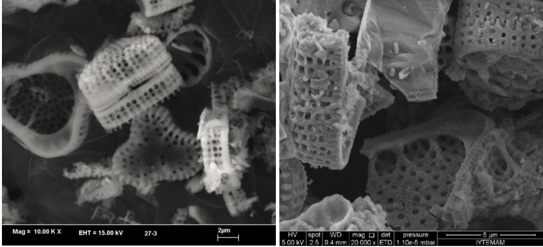
Şekil 4.10 Diatomit (Kizelguhr) hammaddesinin taramalı elektron mikroskobu (SEM) ile yüksek büyütmede çekilmiş görüntüsü.
