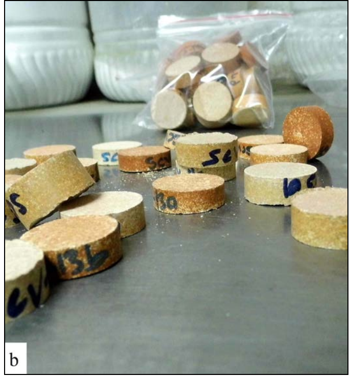
Şekil 3.5. Numuneleri şekillendirmek için kullanılan 15 ton kapasiteli hidrolik pres (a) ve şekillendirilmiş numuneler (b).
