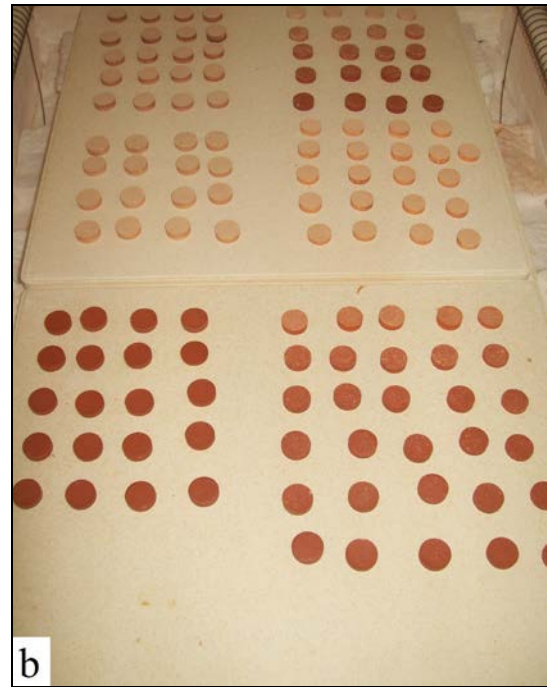
Şekil 3.6 Kalıptan çıkarılan numuneler. Sinterleme öncesi (a) ve sonrası (b).
