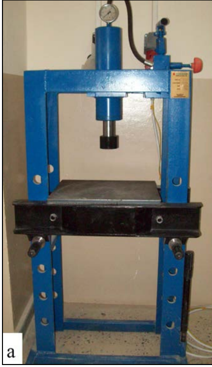
Şekil 3.5. Numuneleri şekillendirmek için kullanılan 15 ton kapasiteli hidrolik pres (a) ve şekillendirilmiş numuneler (b).
