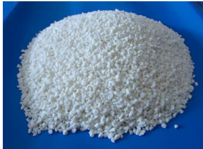
Şekil 3.6.2 MA spineli (%28.32 MgO ve %71.68 Al 2 O 3 ). (Fotoğraf: Koray Kaya 2013).
