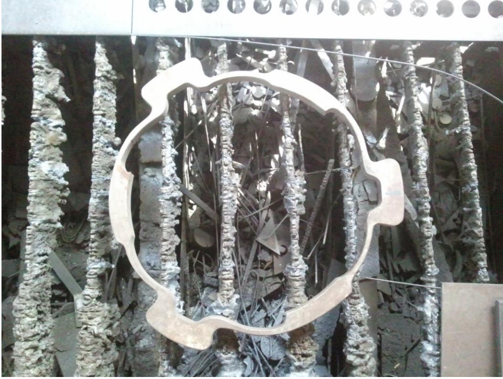
Şekil 15: AISI 1020' den imal edilen halka dişli bağlantı parçası.
