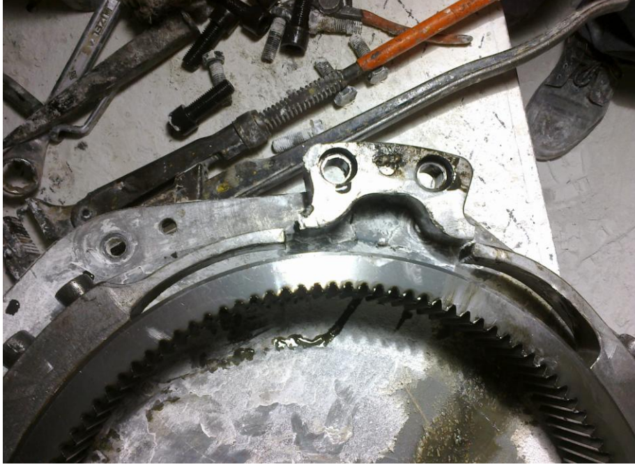
Şekil 17: Hardox 450’den yapılmış halka dişli bağlantı parçası.
