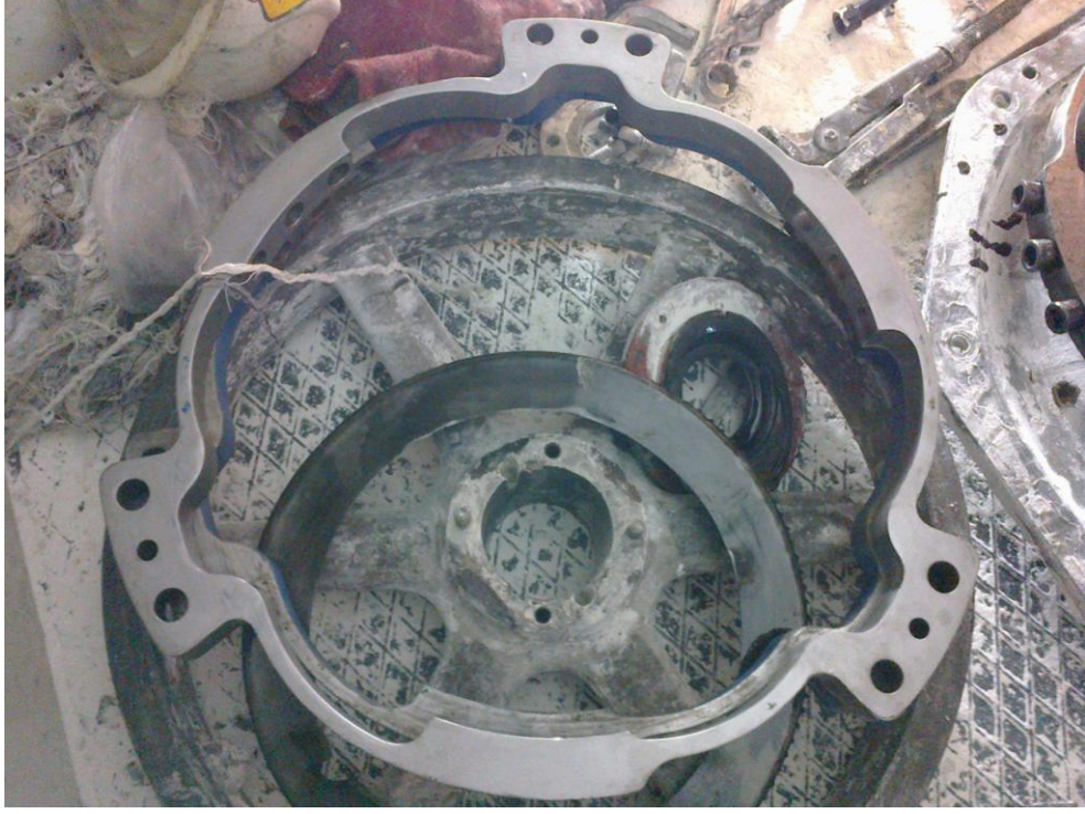
Şekil 16: AISI 1024'den imal edilen halka dişli bağlantı parçası.
