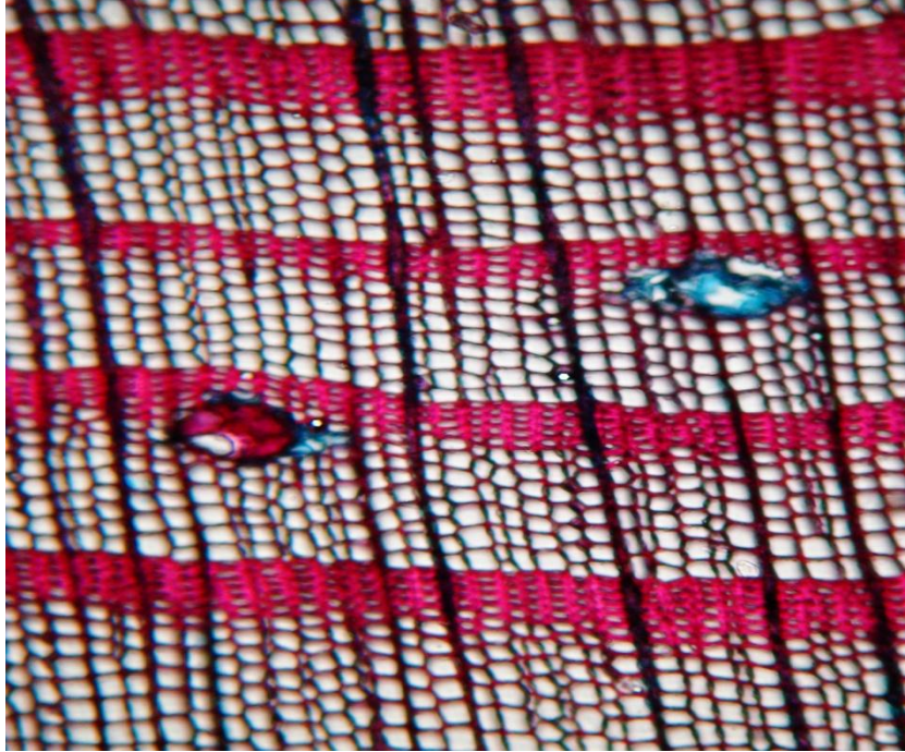
Şekil 27: Camiyanı karaçamı odununun enine kesitinde ilkbahar odunundan yaz odununa geçiş yerinde oluşan reçine kanalları.
