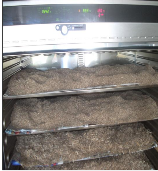
Şekil 51: Yongaların 120 °C' de kurutulması (BİÇER 2013).
