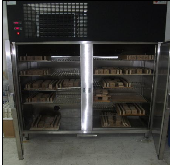
Şekil 57: Test numunelerinin kondisyonlama işlemi (Aziz BİÇER 2013).
