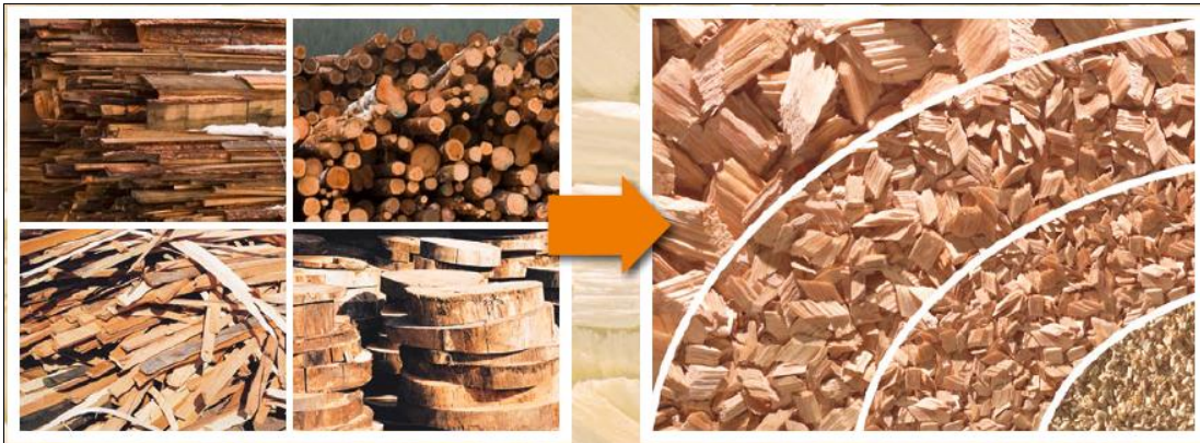
Şekil 28: Odundan ve diğer sanayi atıklarından elde edilen yongalar (URL-10, 2014).
