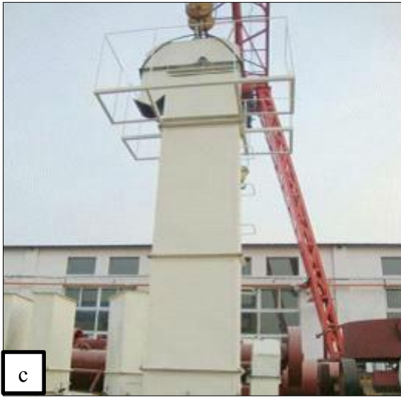
Şekil 36: Taşıyıcılar, a. Zincirli Taşıyıcı, b. Bantlı Taşıyıcı, c. Kovalı Taşıyıcı, d. Vidalı Taşıyıcı (Aziz BİÇER 2013).
