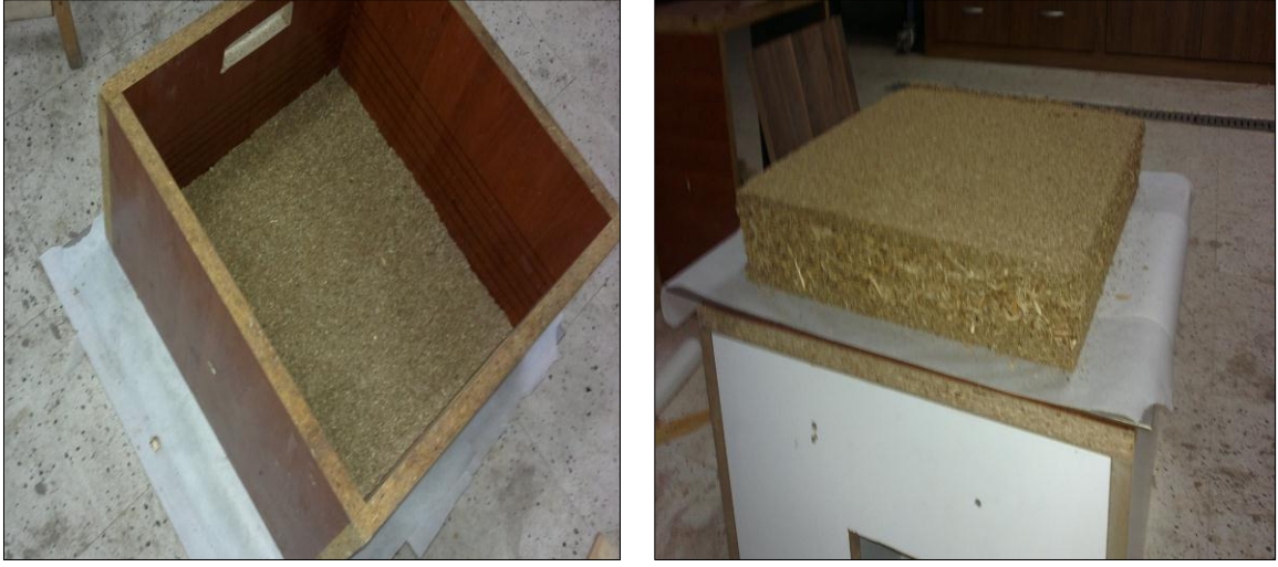
Şekil 53: Yongaların serilmesi ve levha taslağı (Aziz BİÇER 2013).
