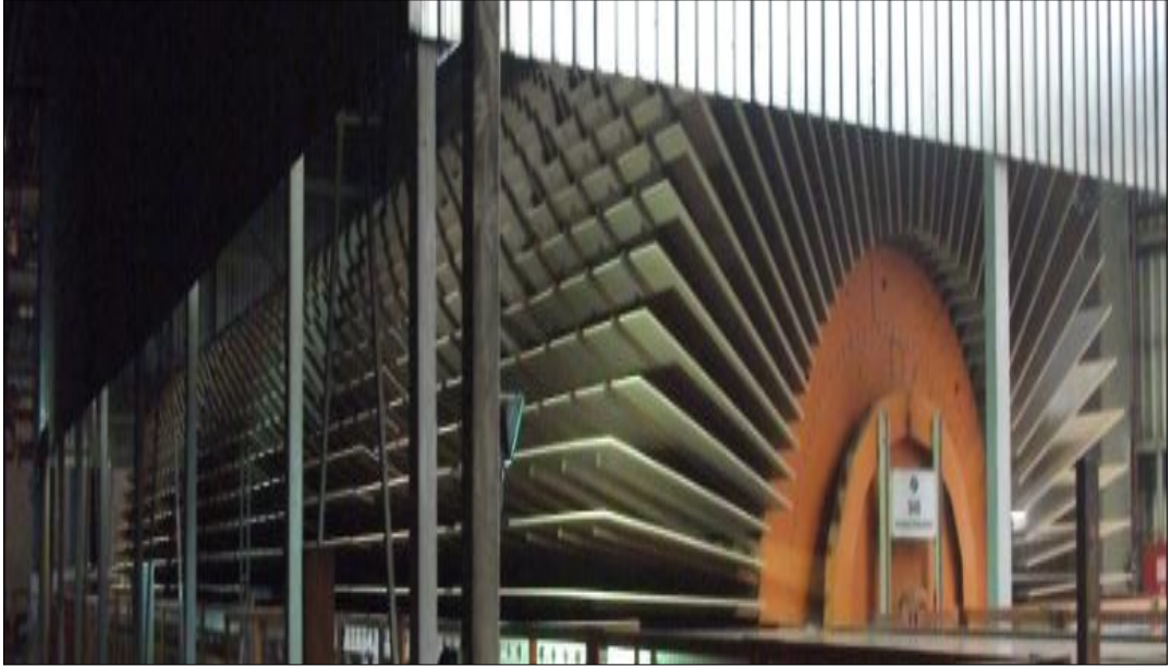
Şekil 46: Yonga levhaların yıldız soğutucularda dinlendirilmesi (URL-10, 2014).
