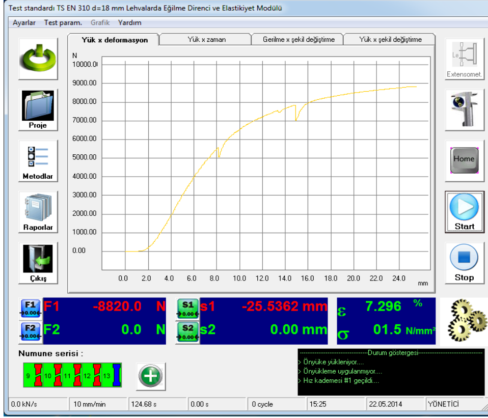
Şekil 27: Suda bekletme sonrası eğilmede kayma deneyi ve grafik şekli.
