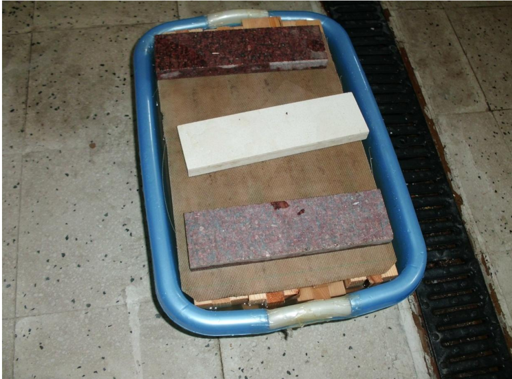
Şekil 26: ÇLK örneklerin suda bekletilme kabı.
