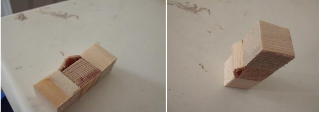
Şekil 40: ÇLK'nın liflere dik basınç direnci kırılma çeşitleri.
