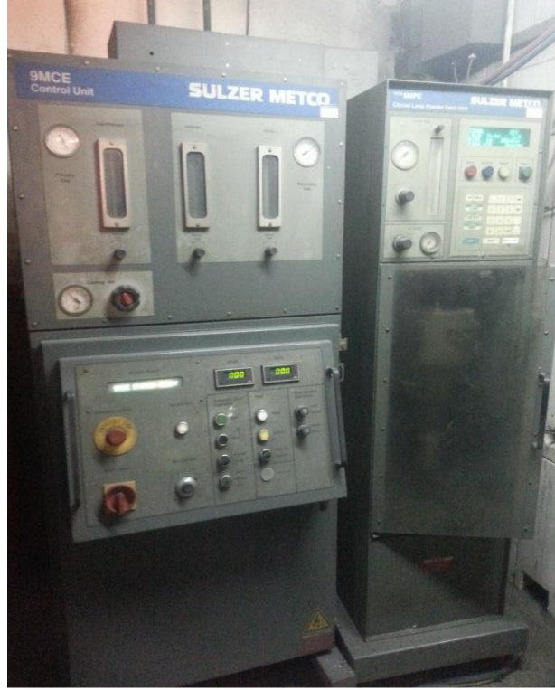
Şekil 42: Bağ kaplama üretiminde kullanılan Sulzer Metco marka APS cihazının görünümü.
