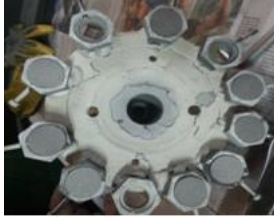
Şekil 44: Deneysel çalışmamızda kullandığımız APS yöntemiyle kaplanmış YSZ üst seramik kaplama tabakasına sahip numunelerin gösterimi.
