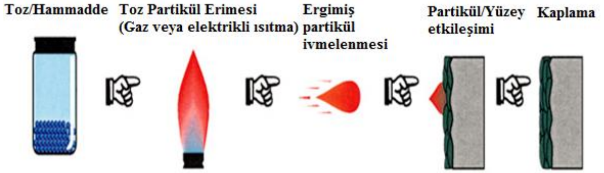
Şekil 3: Termal sprej kaplamanın şematik görünümü (Kahraman, 2000).
