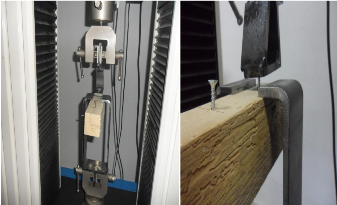
Şekil 38: Çivi ve vida tutma direnci deneyleri (teğet ve radyal kesit) (Fotoğraf: Cengiz YAMAN 2015).
