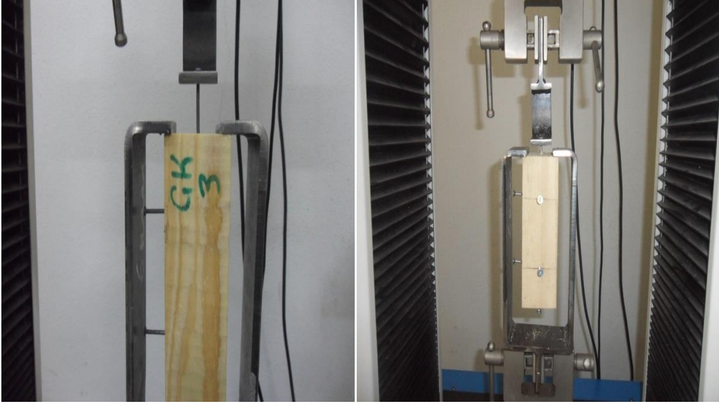
Şekil 37: Çivi ve vida tutma direnci deneyleri (enine kesit) (Fotoğraf: Cengiz YAMAN 2015).
