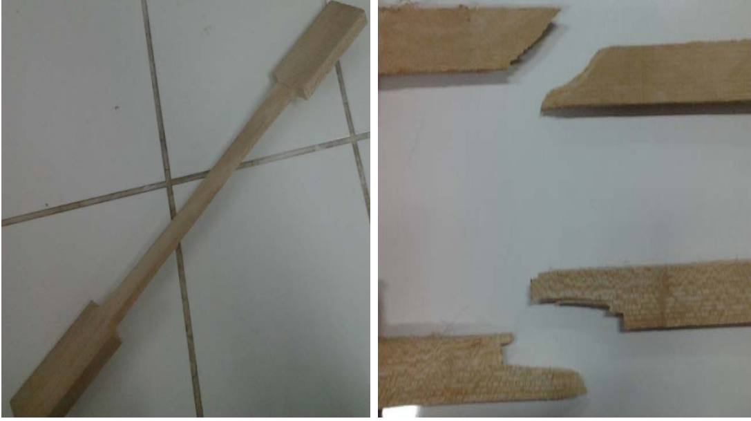
Şekil 36: Liflere paralel yönlü çekme numunesinin görünüşü ve kopma biçimi.
