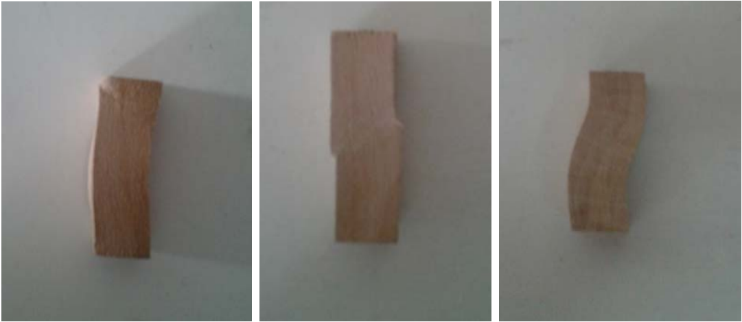
Şekil 39: Boyuna yönlü numunelerin deney sonucunda görünüşü.
