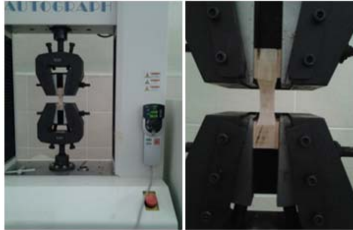
Şekil 33: Dog-bone şekilli numuneler için deneylerin yapılışı.
