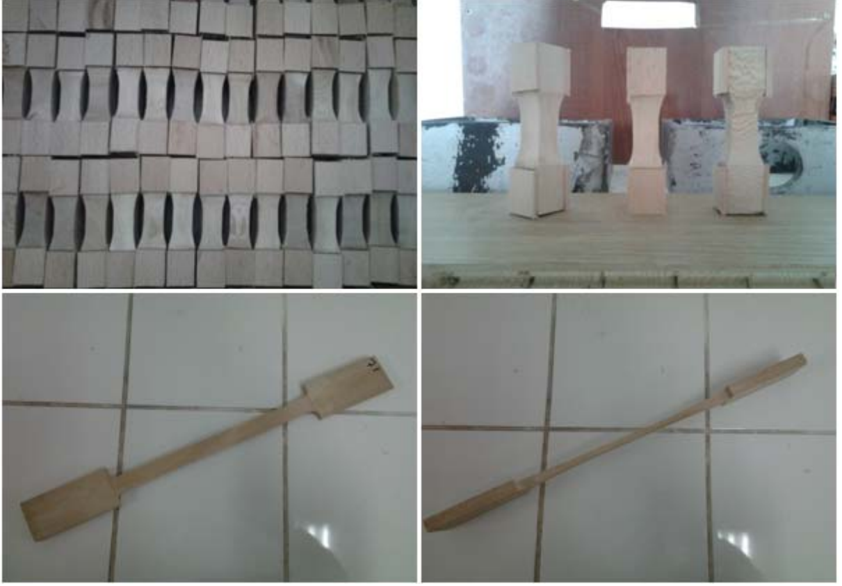
Şekil 27: Numunelerin 5 eksenli CNC ile işlenerek oluşturulmuş son hali.
