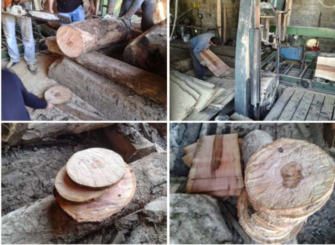
Şekil 22: Çınar tomruklarının arabalı testerede kesilerek plakaların hazırlanması.
