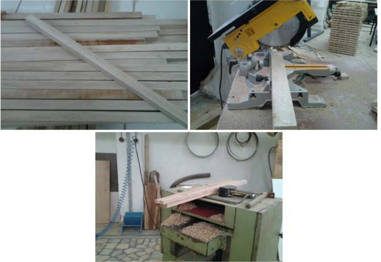
Şekil 25: Boyuna yönde çekme numunelerinin hazırlanması.
