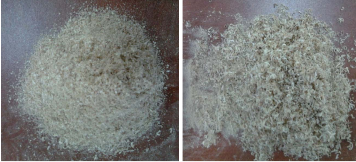
Şekil 32: Boyuna yöndeki kesimlerde oluşan toz halindeki talaş görüntüsü ve teğet ve radyal yöndeki kesimlerde oluşan talaş içinde kopmuş öz ışınlarının görüntüsü.
