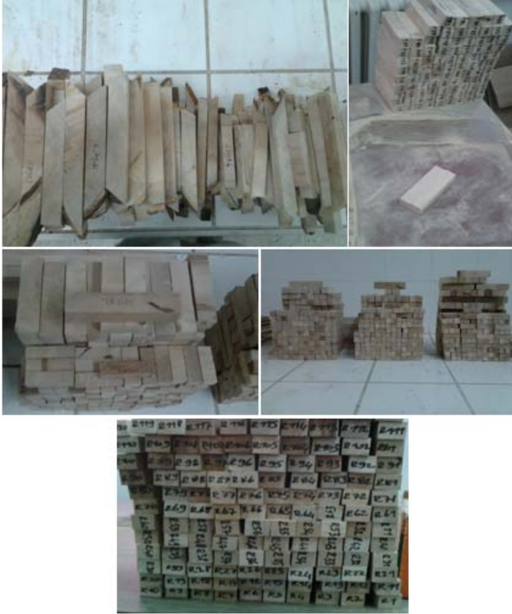
Şekil 23: Radyal, teğet ve boyuna yöndeki çekme (dog-bone) ve basınç numunelerinin hazırlanması.
