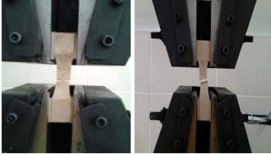
Şekil 34: Teğet ve radyal yönlü numunelerde kopma biçimi.
