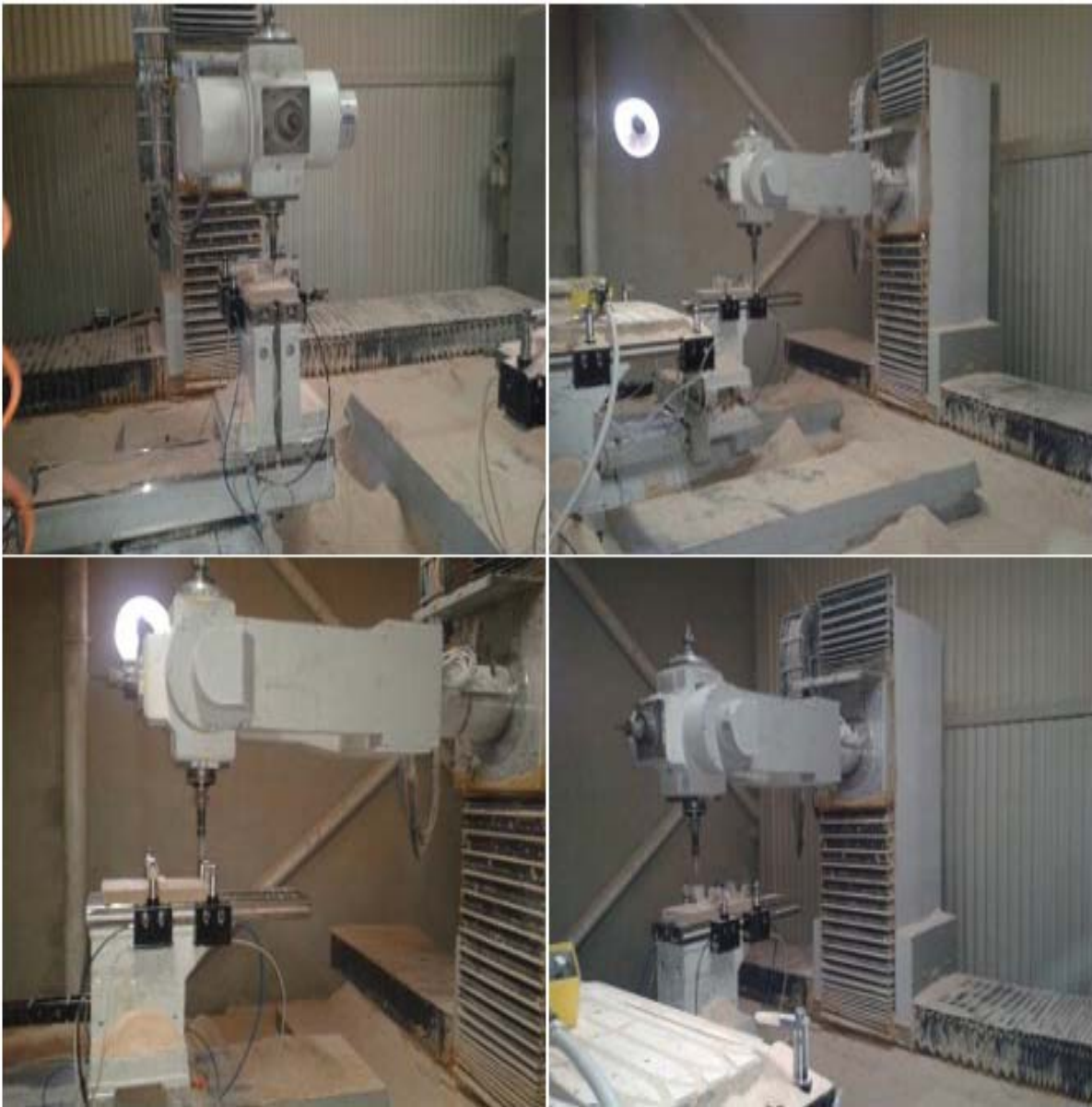
Şekil 26: Numunelerin eksenli CNC ile işlenerek hazırlanması.
