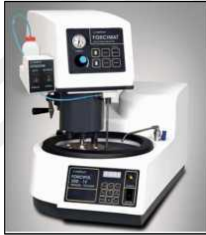
Şekil 61: Zımparalama ve parlatma işleminde kullanılan otomatik zımparalama ve parlatma cihazı (URL-5).
