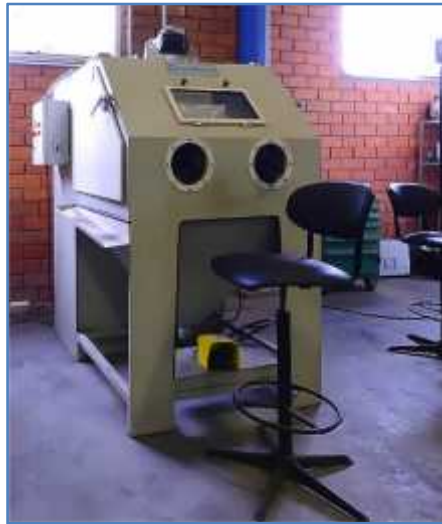
ekil 57: Altık numunelerin kaplama öncesi kumlanmasında kullanılan kumlama cihazı.
