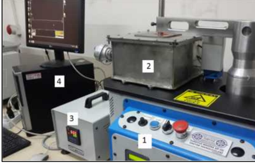
ekil 66: TBC kaplı numunelerin yüksek sıcaklık a ınma testlerinde kullanılan yüksek sıcaklık pin-on-disk test düzene i.
