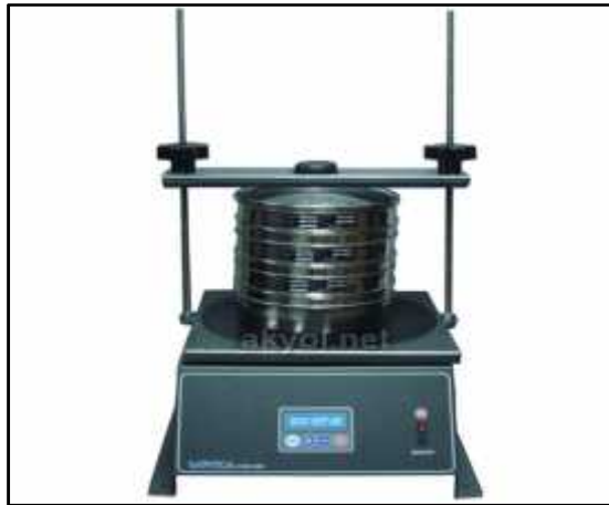
ekil 48: Toz eleme i leminde kullanılan elek sallama makinesi (URL-2).
