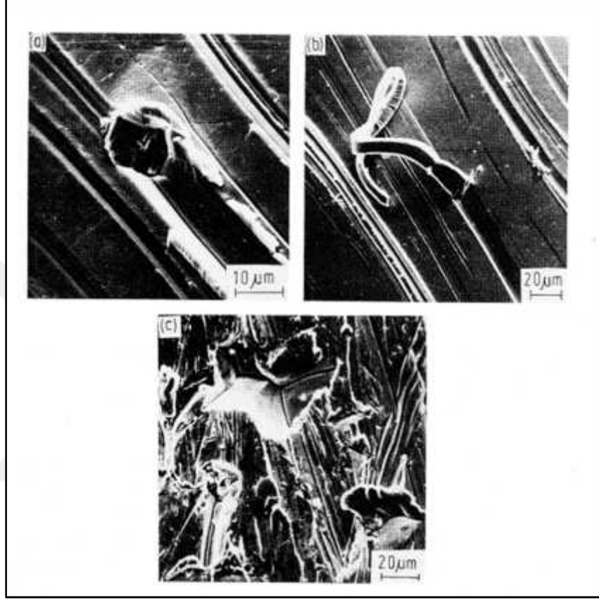
ekil 38: Abrazif mineraller ile çelik yüzeyler arasındaki etkileimin SEM görüntüleri. a: mikro-izolu mu, b: mikro-tala olu mu, c: mikro-çatlak olu mu (Zum Gahr, 1987).
