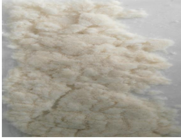
Şekil 11:Alfa selüloz partikülleri.
