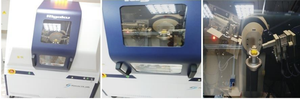
Şekil 25: XRD cihazına örnek yerleştirilmesi.
