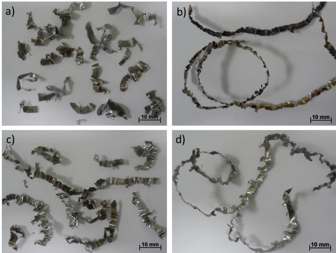
Şekil 37: Birinci ve son pasodan sonra a-C:N/TiAlN (a-b) ve ticari TiN/TiAlN kaplamalı takımlar (c-d) ile edilen talaş şekilleri.
