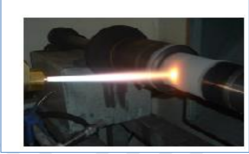
Şekil 14: Hvof kaplama yönteminin uygulanışı (Yonar, 2009).
