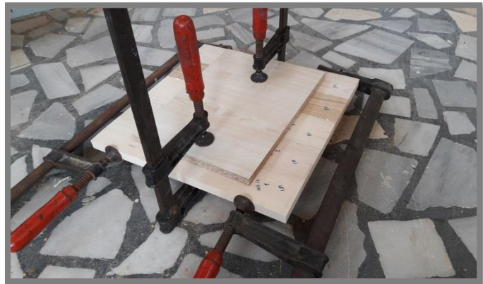
Şekil 27: Örneklerin işkence ile sıkıştırılması (Fotoğraf: Z. Eda ÖZAN, 2017).
