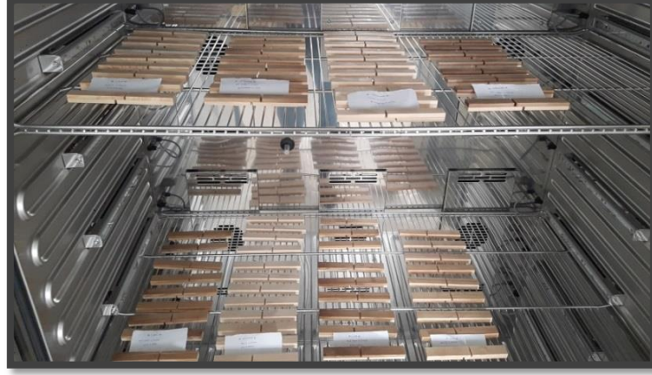
Şekil 24: Deney örneklerinin iklimlendirme cihazında bekletilmesi (Fotoğraf: Z. Eda ÖZAN, 2017).
