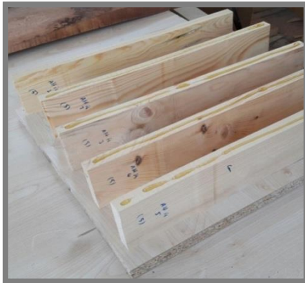
Şekil 27: Örneklerin işkence ile sıkıştırılması (Fotoğraf: Z. Eda ÖZAN, 2017).
