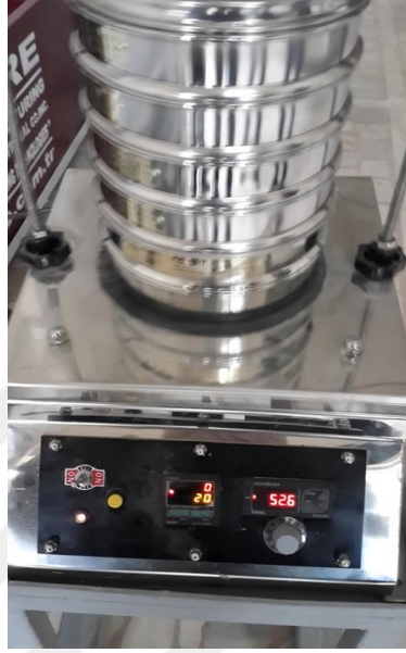
Şekil 21: Sarsma makinası ile yumurta kabuğu tozu elek analizi.
