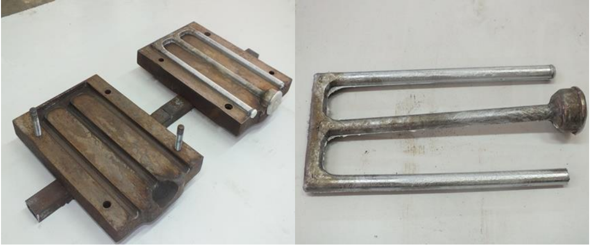
Şekil 23: Döküme hazır olan metal kalıp ve numune.
