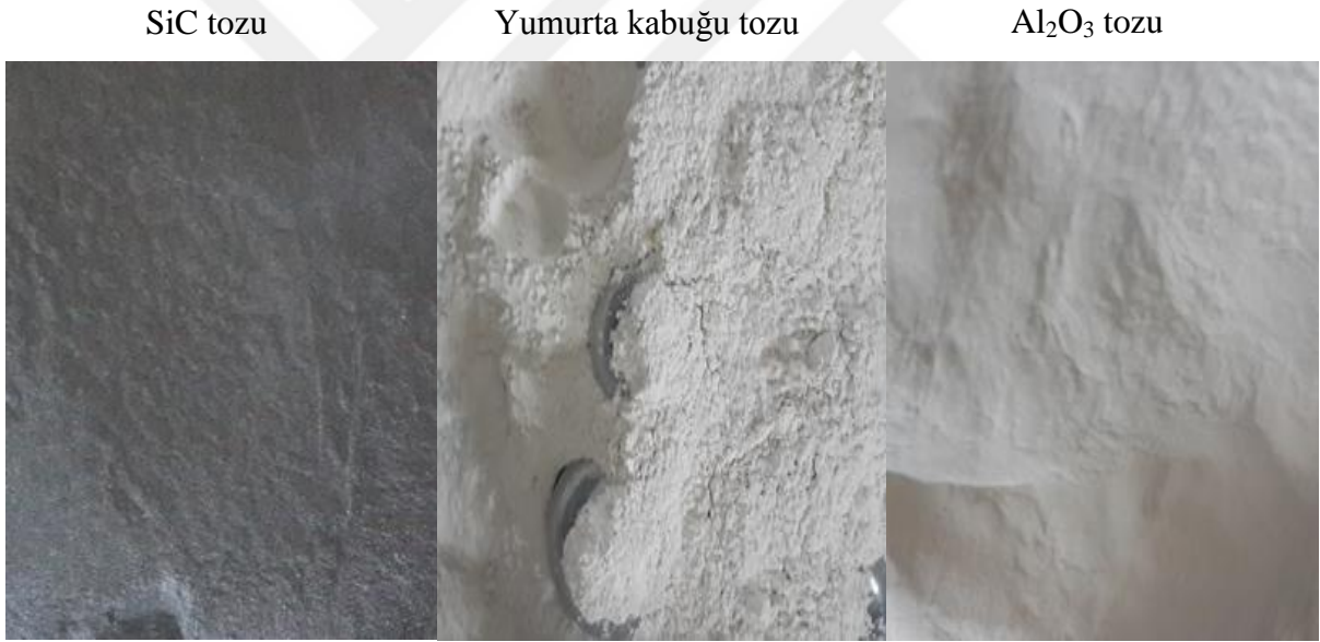
Şekil 25: Hibrit kompozit üretiminde kullanılan takviye malzemeleri.
