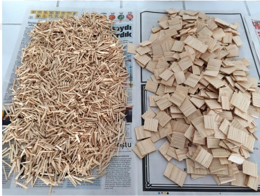
Şekil 14: Kibrit çöpü kızılcım yongaları (sol), kraft pişirme için kullanılan kızılcım yongaları (sağ) (Foto; M.TAŞ, 2016).
