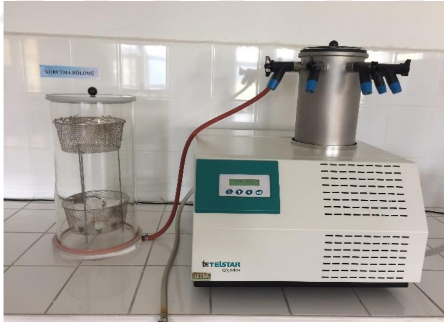
Şekil 15: Freeze dryer kurutucusuna yerleştirilmiş kızılçam odun ve hamur numuneleri (Foto; M.TAŞ, 2017).
