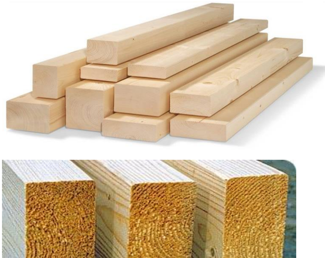
Şekil 19: Sarıçamdan elde edilmiş keresteler
