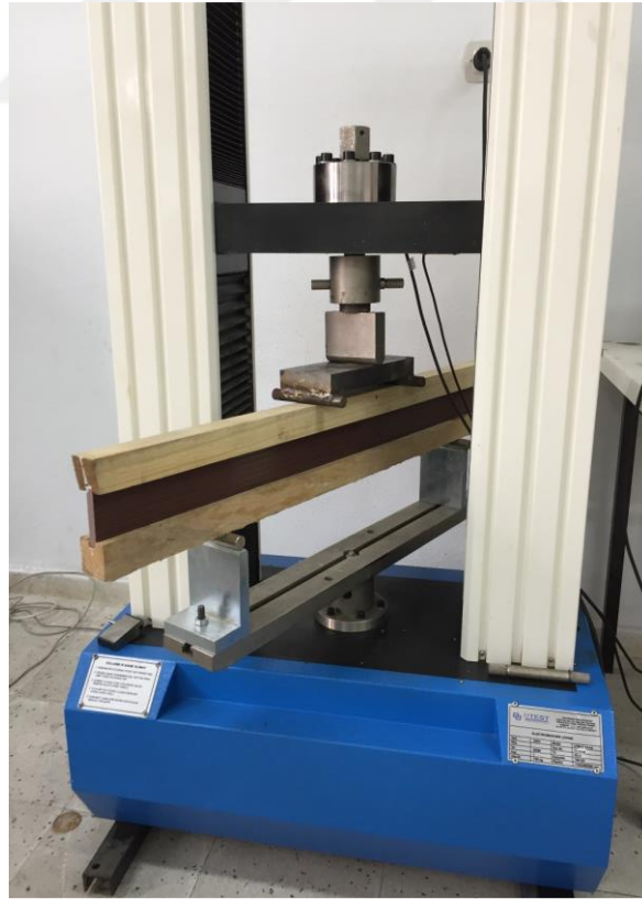
Şekil 25: Kirişlerde Tahribatlı Deney Düzeneği
