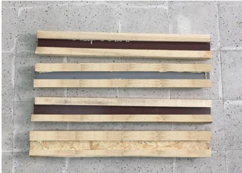
Şekil 22: Tasarlanan I kiriş Örnekleri
