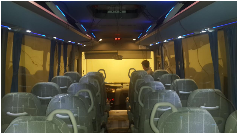
Şekil 3.24: Isıl çift yerleşimi tamamlanmış araç.
