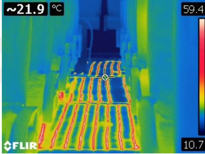
Şekil 4.31: 0 °C dış sıcaklıkta termal kamera zemin görüntüsü.
