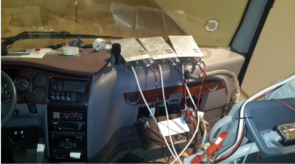
Şekil 3.31: Güç kaynaklarının yerleşimi.
