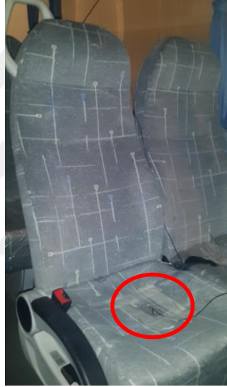
Şekil 4.31: Koltuk oturak bölgesi ısı çift yerleşimi.
