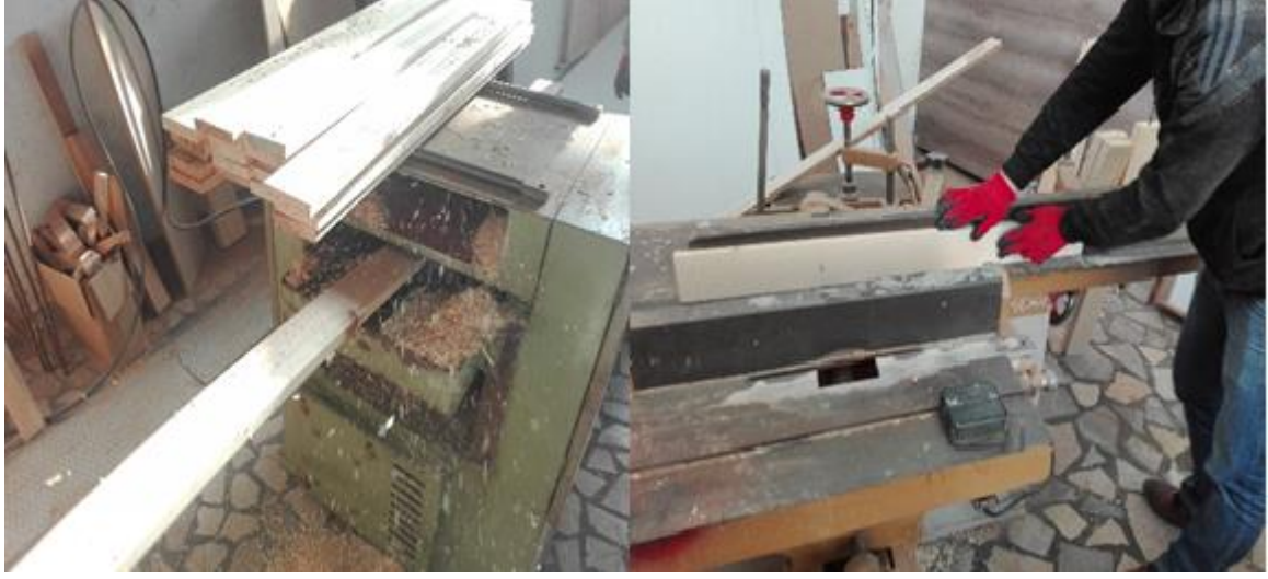
Şekil 3. 2: Kalınlık makinesinde teğet yüzey, planya makinesinde radyal yüzey düzgünlüğünün sağlanması ( Foto: M. GÜLCEMAL, 2018).
