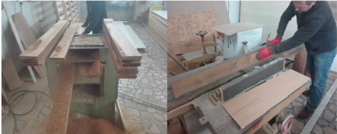
Şekil 3. 12: ÇLK deney malzemelerinin yüzey düzgünlüklerinin sağlanması (M. GÜLCEMAL, 2018).
