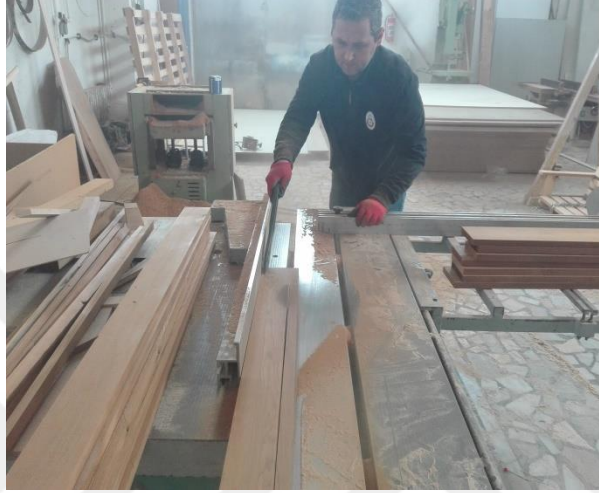
Şekil 3. 3: ÇLK alt ve üst deney malzemelerinin genişlikleri boyutlandırması (Foto: M. GÜLCEMAL, 2018).
