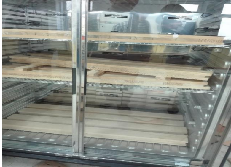
Şekil 3. 10: ÇLK malzemelerinin klimatize işlemi (Foto: M. GÜLCEMAL, 2018).
