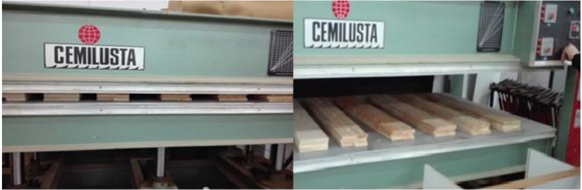
Şekil 3. 8: ÇLK malzemelerinin yapışmada presleme işleme (Foto: M. GÜLCEMAL, 2018).
