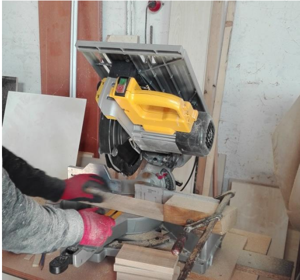
Şekil 3. 4: ÇLK orta tabaka parçalarının baş kesme makinasında hazırlanışı (Foto: M. GÜLCEMAL, 2018).
