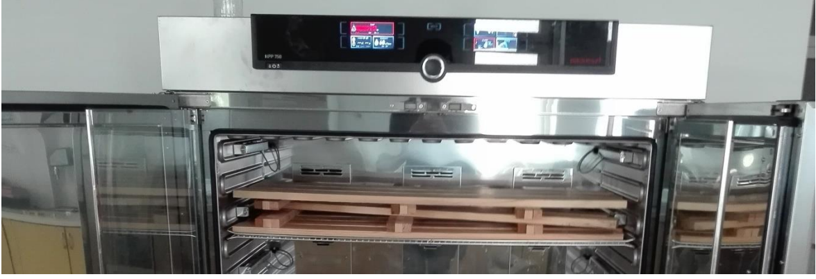
Şekil 3. 1: Test Örneklerinin iklimlendirme cihazında kurutulması ve istiflenmesi (Foto; M. GÜLCEMAL, 2018).
