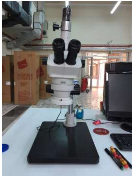
Şekil 3.4: Vision SX 45 Stereo zoom mikroskop
