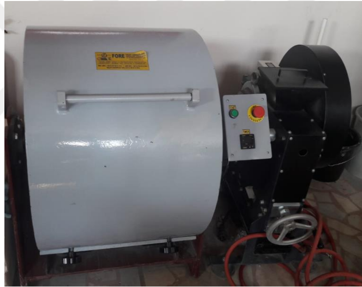
Şekil 5.11: Cantabro aşınma kaybı deney aleti.
