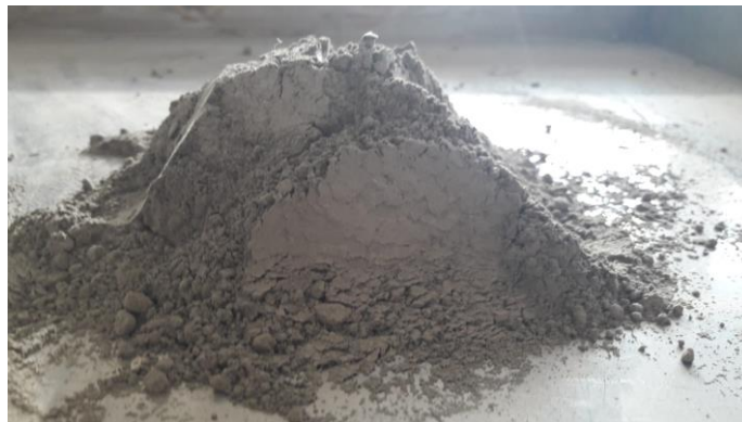
Şekil 5.5: İlave filler malzemesi olarak kullanılan uçucu kül.
