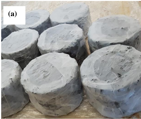
Şekil 5.8: Sıkıştırılmış numunelerin boşluk analizleri. a. numunelerin parafilmle kaplanması, b. tartımların yapıldığı özgül ağırlık sehpası.
