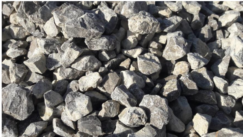
Şekil 5.3: Çalışmada kullanılan kireçtaşı kaba agregası.
