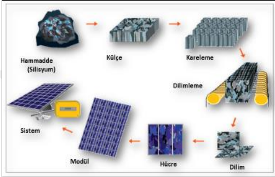
Şekil 4.6: FV panel oluşumu
