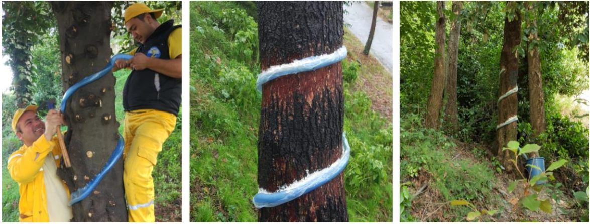
Şekil 2.4: Gövdeden akış ölçümü için ağaç gövdelerinin hazırlanması.
