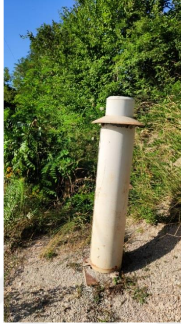
Şekil 2.2: Açık alana düşen yağışı belirlemede kullanılan yağışölçer.
