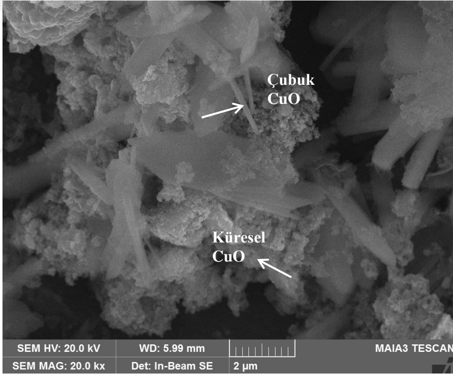
Şekil 4.4: Yanma yöntemiyle hazırlanan CuO nanopartiküllerinin SEM görüntüsü.
