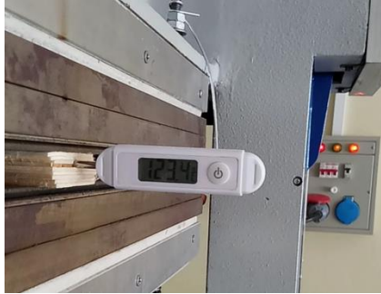
Şekil 3.1: Kaplama katmanlarının içinde sıcaklık yayılımının ölçümü.
