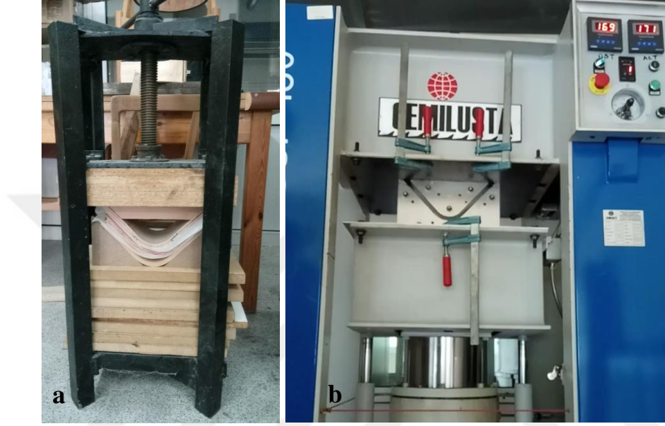
Şekil 4.4: byTKK üretiminde kullanılan a) soğuk, vidalı ön pres makinesi, b) sıcak hidrolik bükme pres makinesi.
