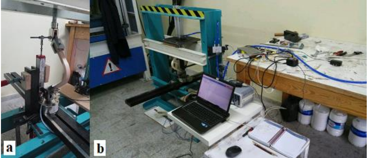
Şekil 4.6: Pnömatik yorulma deney düzeneği a) numunelerin bağlantı şekli b) yükleme ve kontrol sistemi.
