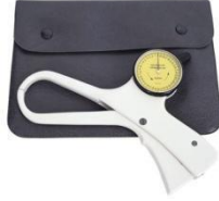
Şekil 3. Deri kıvrım kalınlığı ölçüm aracı.
