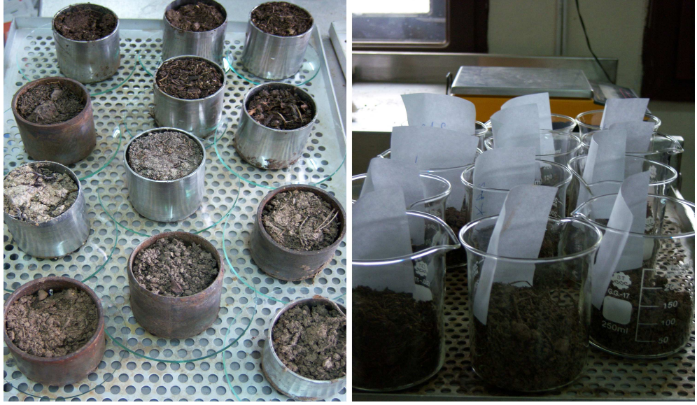
Şekil 7. Toprak hacim ağırlığını belirlemek için araziden alınan silindir örnekleri ve diğer toprak özelliklerini belirlemek için alınan toprak örnekleri
