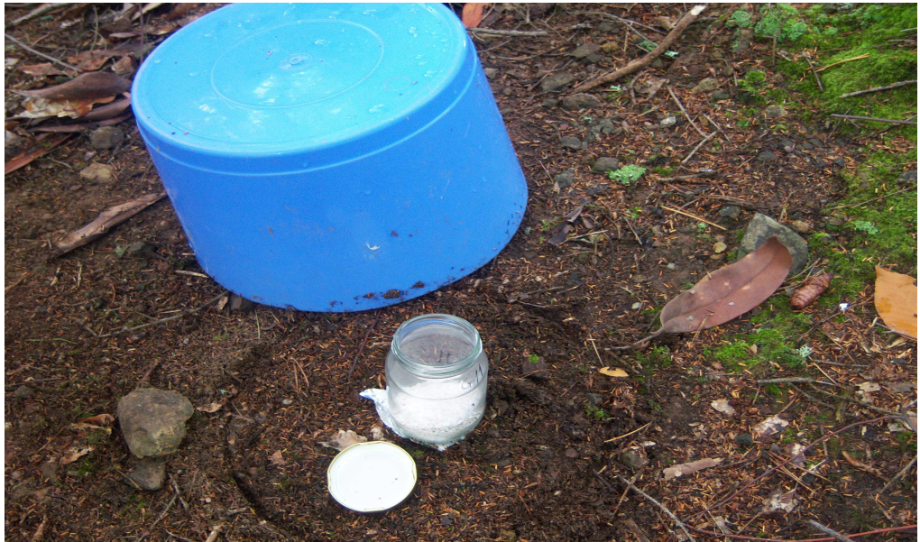
Şekil 13. Çalışma alanlarında yapılan solunum örnekleme
