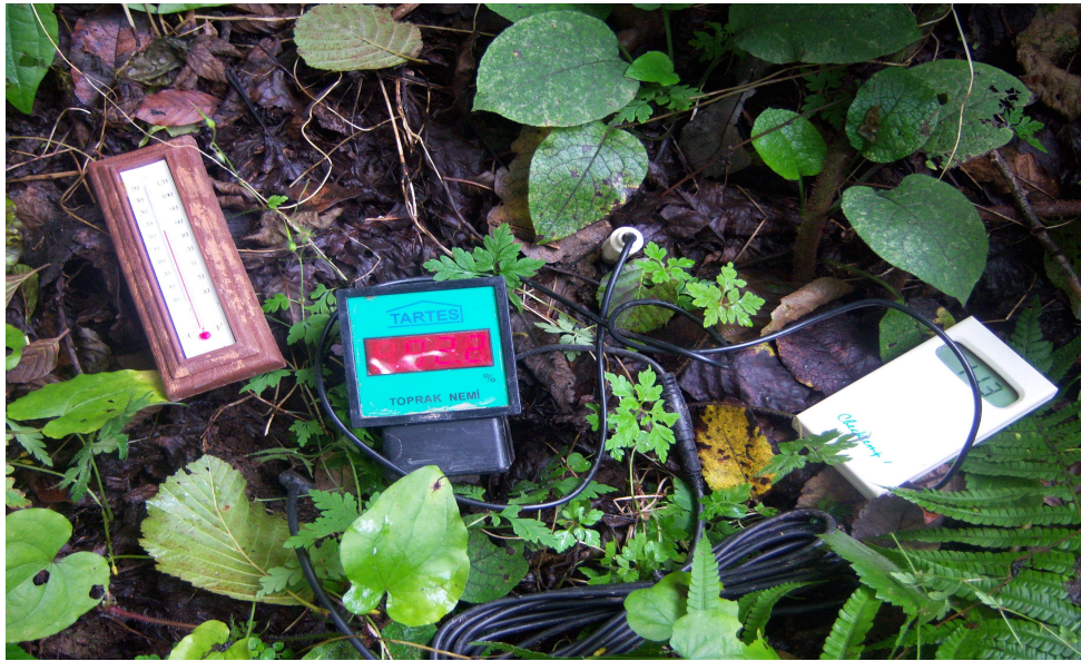
Şekil 12. Çalışma alanlarında meşcere altı sıcaklığı, toprak nemi ve toprak sıcaklığı değerlerinin ölçülmesi
