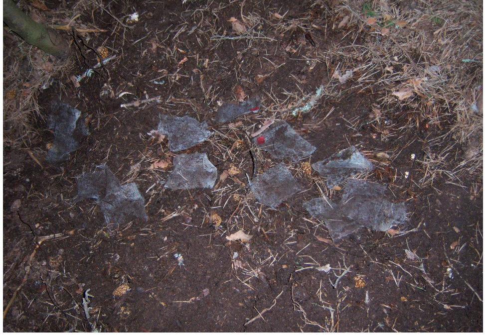
Şekil 9. Toprağın 10-20 cm derinlik kademelerine bırakılan ölü örtü ayrışma poşetleri
