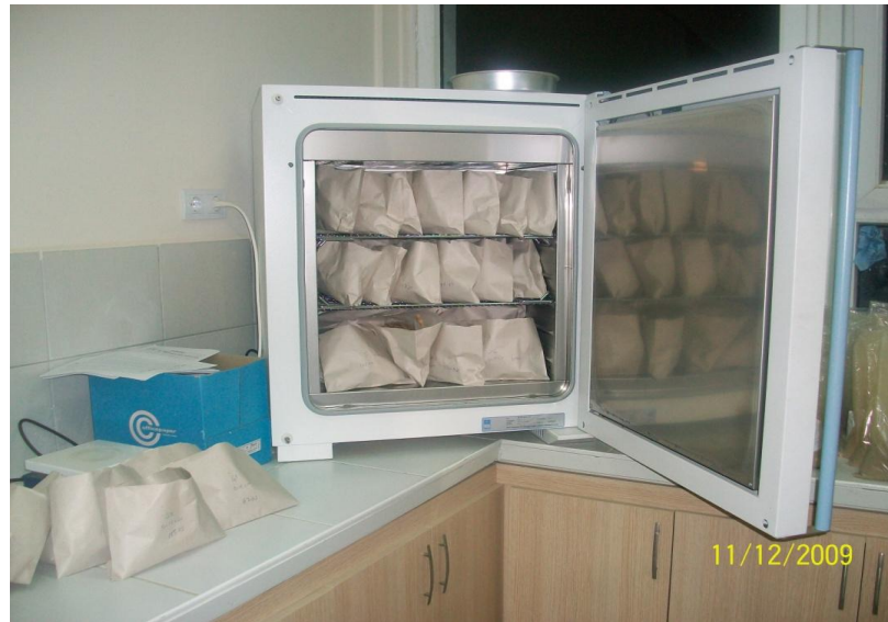
Şekil 5. Kese kâğıtlarına yerleştirilmiş olan köklerin kurutma fırınlarında kurutulması
