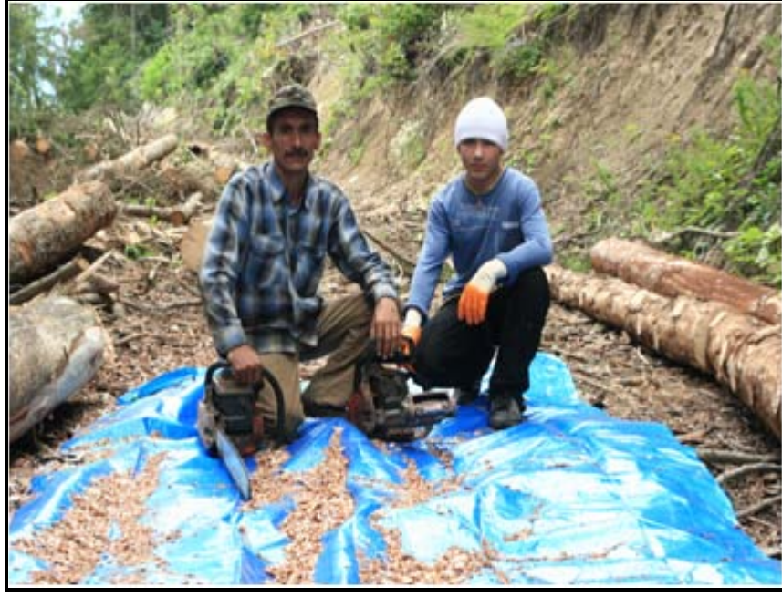
Şekil 12. Motorlu testerenin ucuna takılan kabuk soyma aparatı ile çalışma
