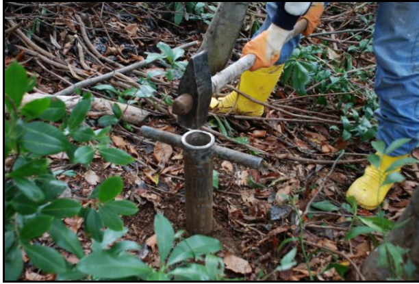
Şekil 7. Silindirle toprak örneği alınması
