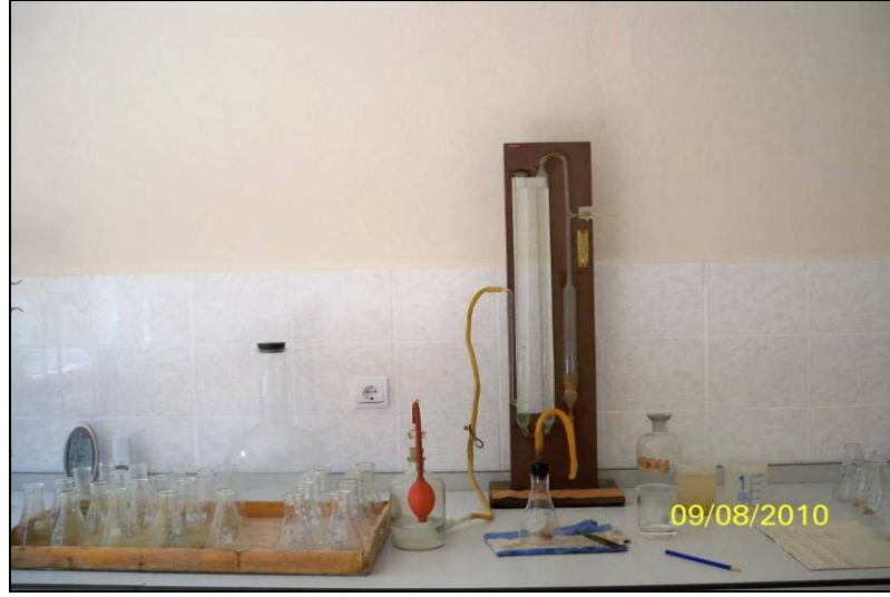
Şekil 27. Laboratuarda total kireç tayinin yapıldığı andan bir görünüm.
