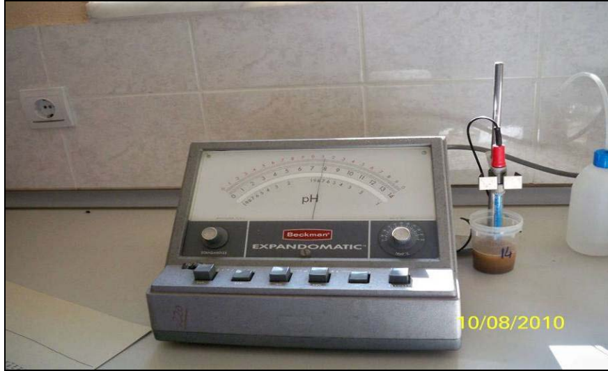
Şekil 25. Laboratuarda pH tayinin yapıldığı andan bir görünüm.
