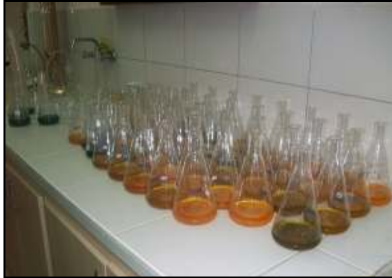
Şekil 13. Organik madde tayini için hazırlanmış toprak örnekleri
