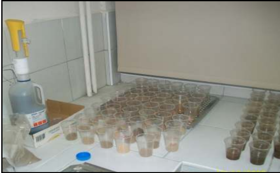
Şekil 11. pH tayini için toprak örneklerinin hazırlanması
