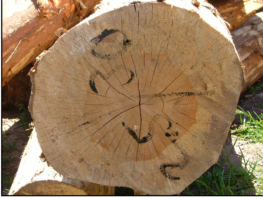
Şekil 15. Mavileşmeye maruz kalmamış tomruk enine kesiti.
