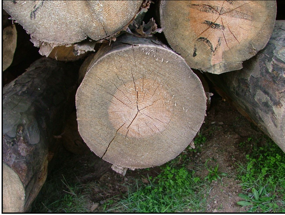
Şekil 17. Orta düzeyde mavileşmeye maruz kalmış tomruk enine kesiti.
