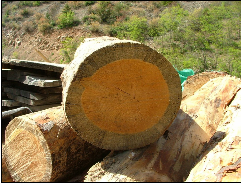
Şekil 16. Düşük düzeyde mavileşmeye maruz kalmış tomruk enine kesiti.
