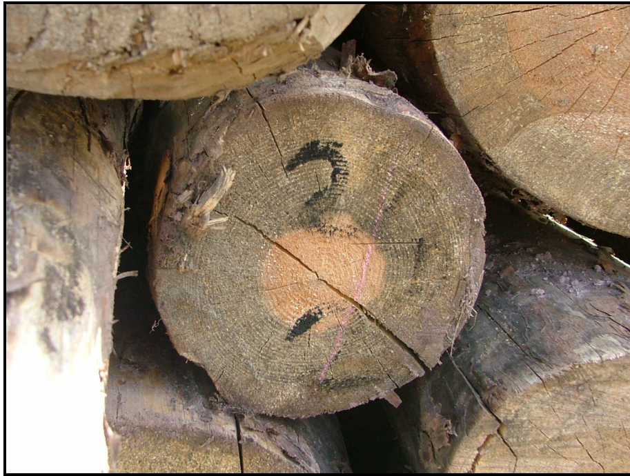
Şekil 18. Yüksek düzeyde mavileşmeye maruz kalmış tomruk enine kesiti.
