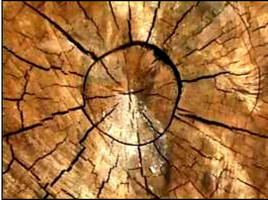
Şekil 7. Esmer çürüklüğe uğramış bir tomruk enine kesiti.
