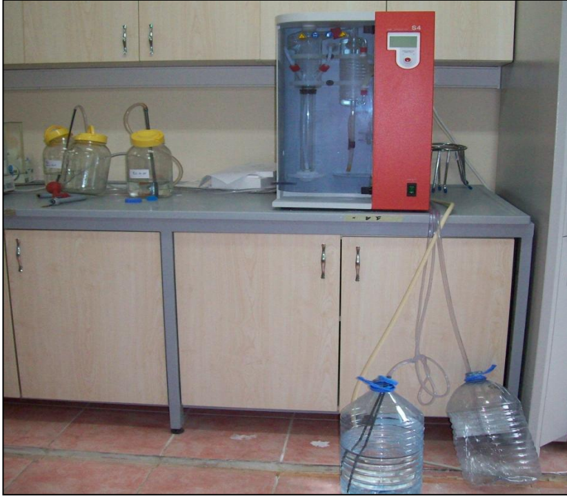
Şekil 10. Total Azot Tayini Yapılırken Titrasyon İşleminin Bir Görünümü
