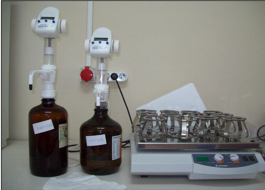
Şekil 8. Mineral Azot Analizi Ölçümünde Titrasyon Yapılırken Bir Görünüm
