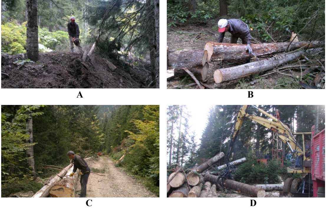
Şekil 3. Üretim işçilerinin yaptığı faaliyetler A: Ağaç kesme, B: Yol kenarına sürütme için tomruk bağlama, C: Kabuk soyma, D: Hava hattı yardımı ile bölmeden çıkarma
