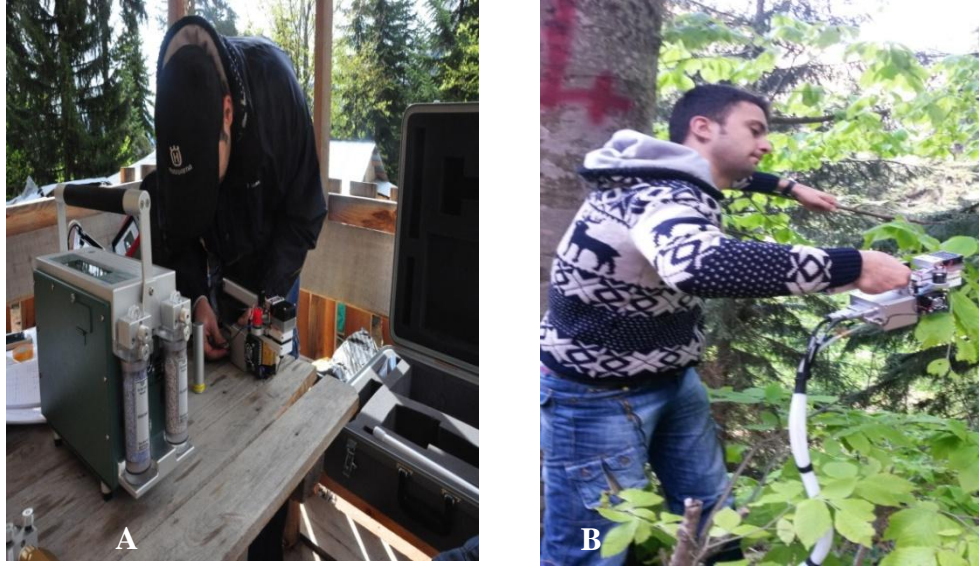
Şekil 5. Licor 6400 XT cihazıyla çalışma A) Cihazın başlığını ölçüm için hazırlama, B) Alanda cihaz ile ölçüm
