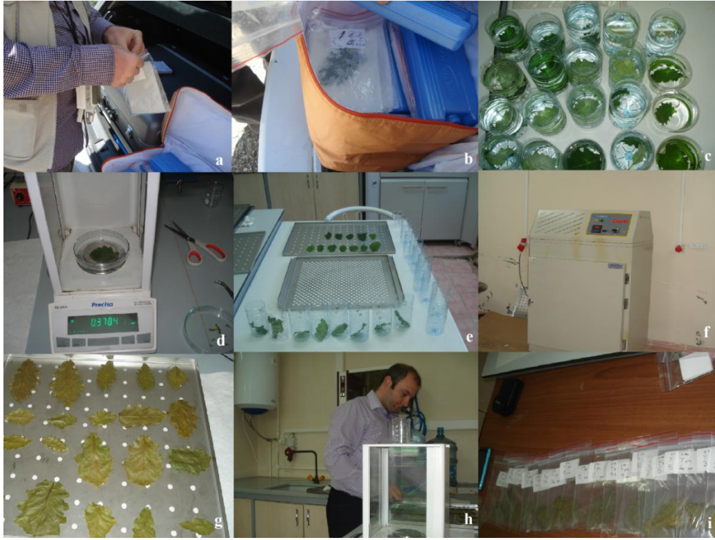
Şekil 15. Yaprakta kuru ağırlık, SLA, LMA ve LDMC ölçümleri. a) Yaprakların distile su ile ıslatılarak kilitli poşetlere aktarılması b) Poşetlerin buz kasetleri arasında soğuk saklama ve taşıma kabı ile araziden getirilmesi c) Yaprakların +4°C ye yerleştirilmeden önce distile su dolu kapların içine konması d) Yapraklarda suya doymuş taze ağırlık ölçümleri e) Yaprakların kurutma öncesi numaralandırılarak fırın tepsilere dizilmesi f) Kurutma fırınında 70°C de 72 saat bekletme g) Fırın kurusu hale gelmiş yapraklar h) Yapraklarda kuru ağırlık ölçümleri i) Sonraki analizler için tekrar kilitli poşetlere aktarılmış yapraklar.
