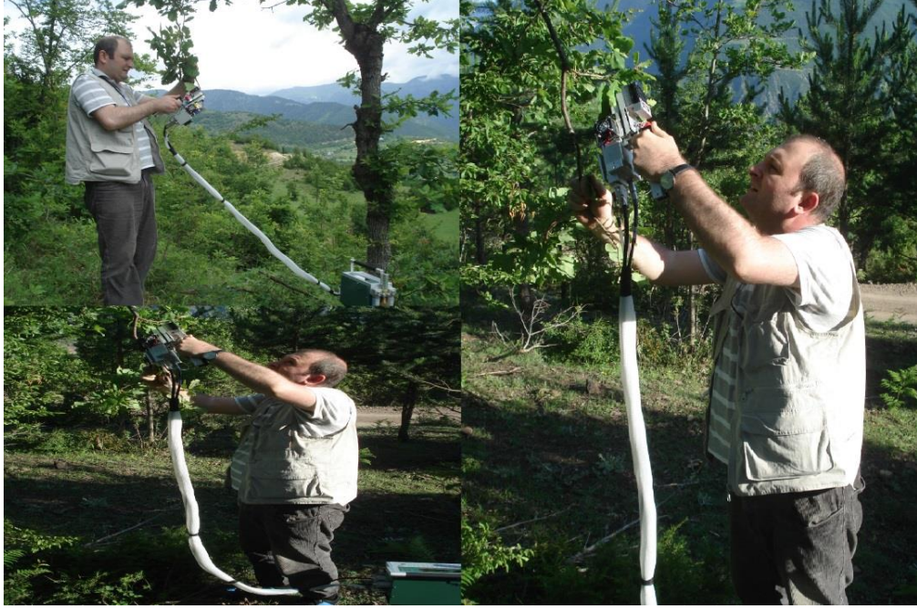
Şekil 12. LI-6400XT cihazı ile arazide gaz değişimi ölçümleri
