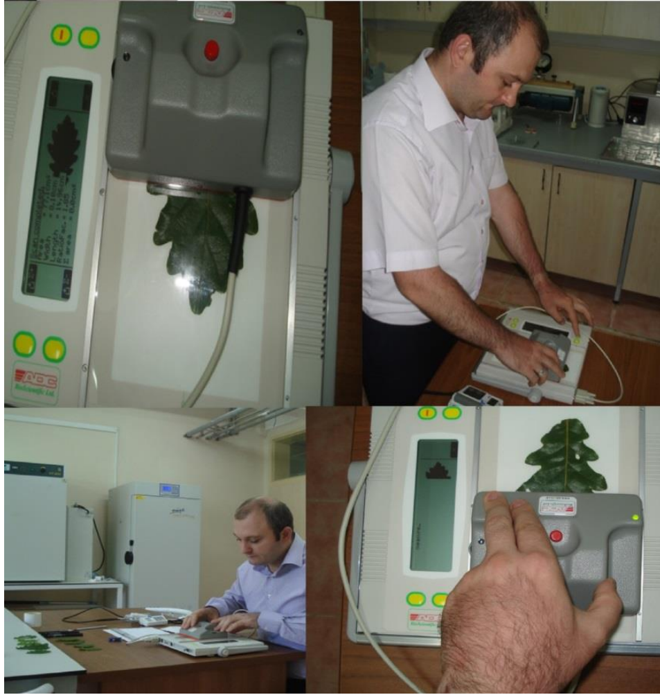
Şekil 16. AM-350 cihazı ile yaprakta boy, genişlik, alan ve oran faktörü ölçümleri
