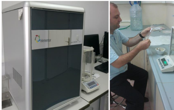
Şekil 17. Vario Macrocube cihazı ile yaprakta % N,C,H,S içerik analizi
