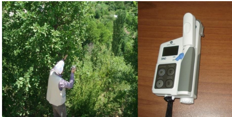
Şekil 14. SPAD-502Plus portatif klorofilmetre ile klorofil içerik ölçümü
