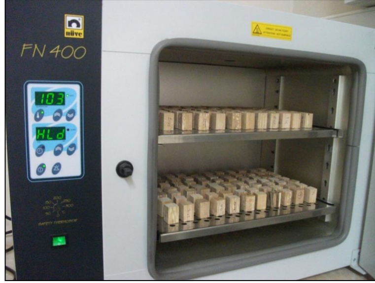
Şekil 11. Örnekler Tam Kuru Hale Gelinceye Kadar Fırında 103 \pm 2 °C De Kurutulması
